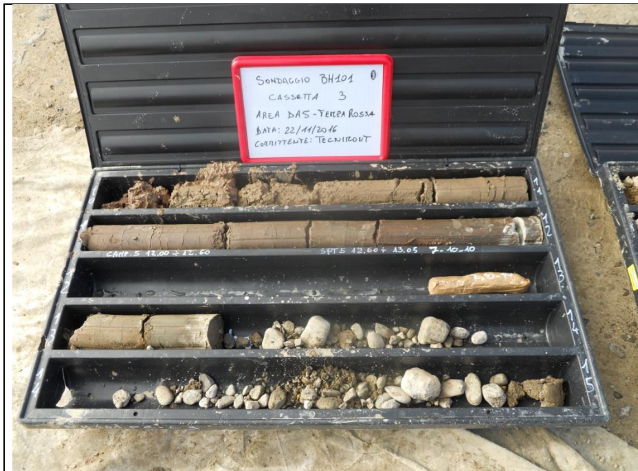
SONDAGGIO BH 101PZ: da m. 10.00 a m. 15.00
