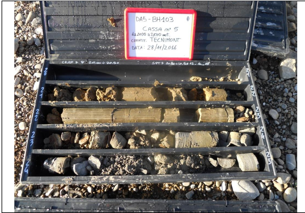
SONDAGGIO BH 103PZ: da m. 20.00 a m. 25.00
