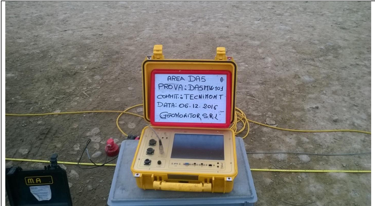
PROSPEZIONE SIMICA MASW MW101
