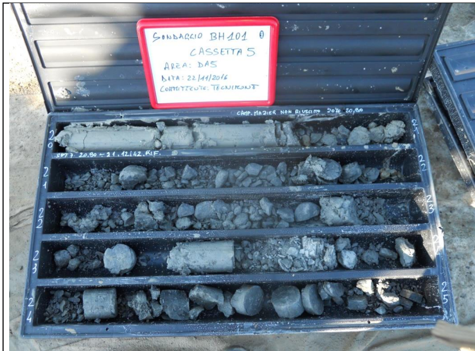
SONDAGGIO BH 101PZ: da m. 20.00 a m. 25.00
