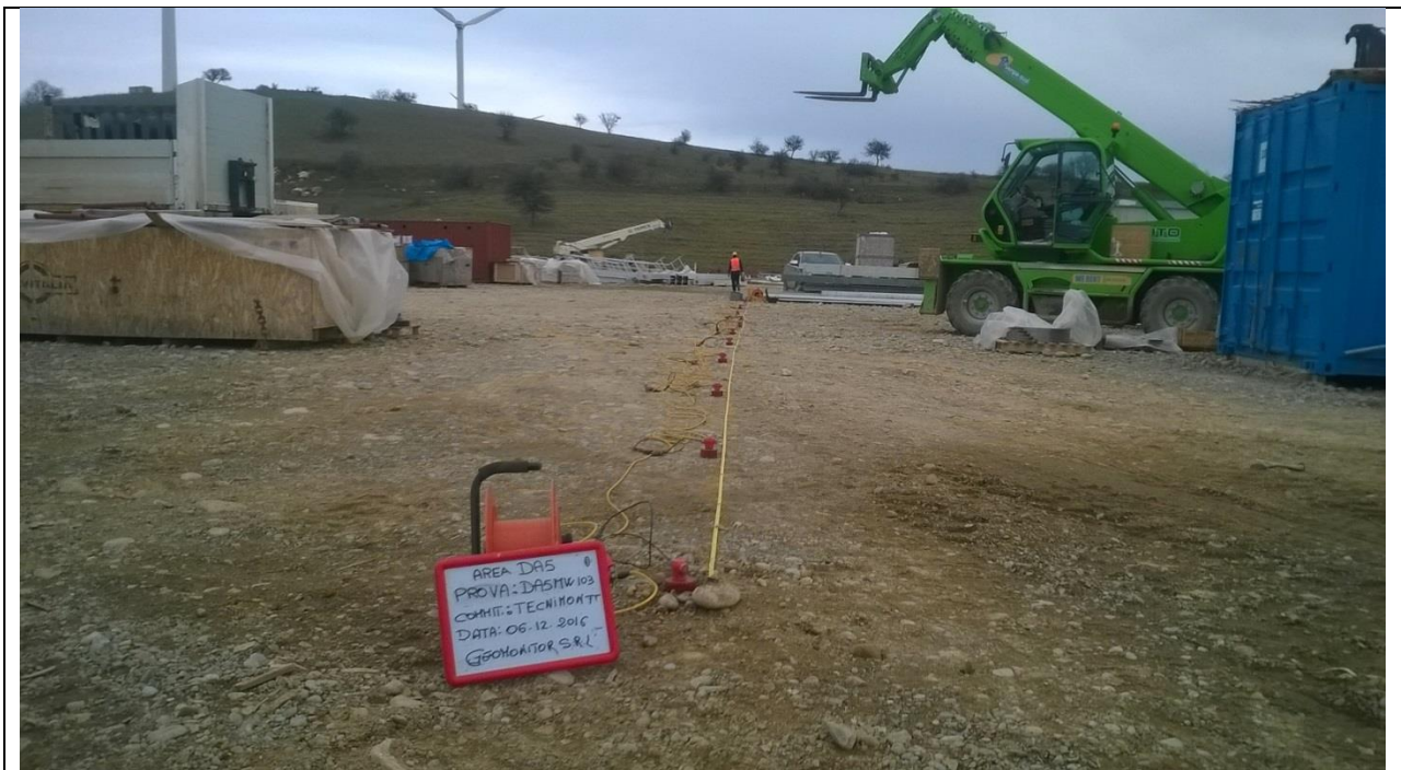
PROSPEZIONE SIMICA MASW MW103
