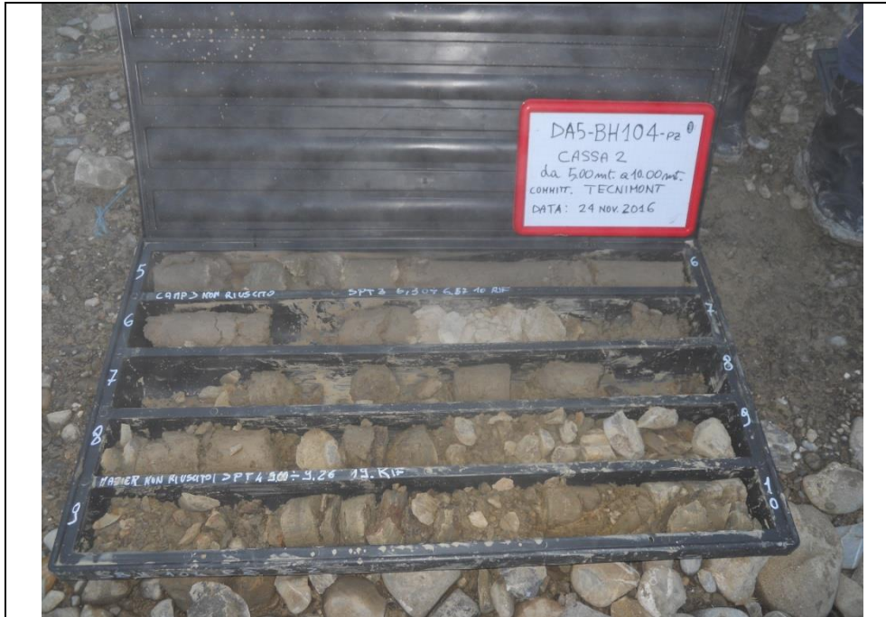
SONDAGGIO BH 104PZ: da m. 5.00 a m. 10.00
