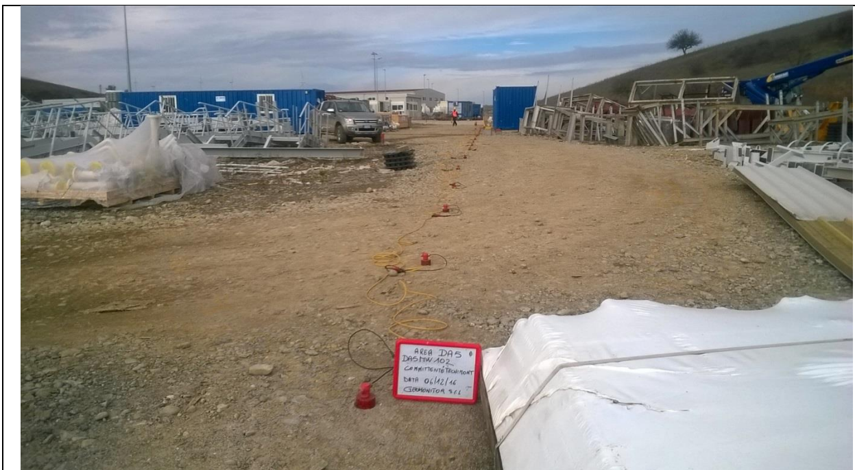
PROSPEZIONE SIMICA MASW MW102
