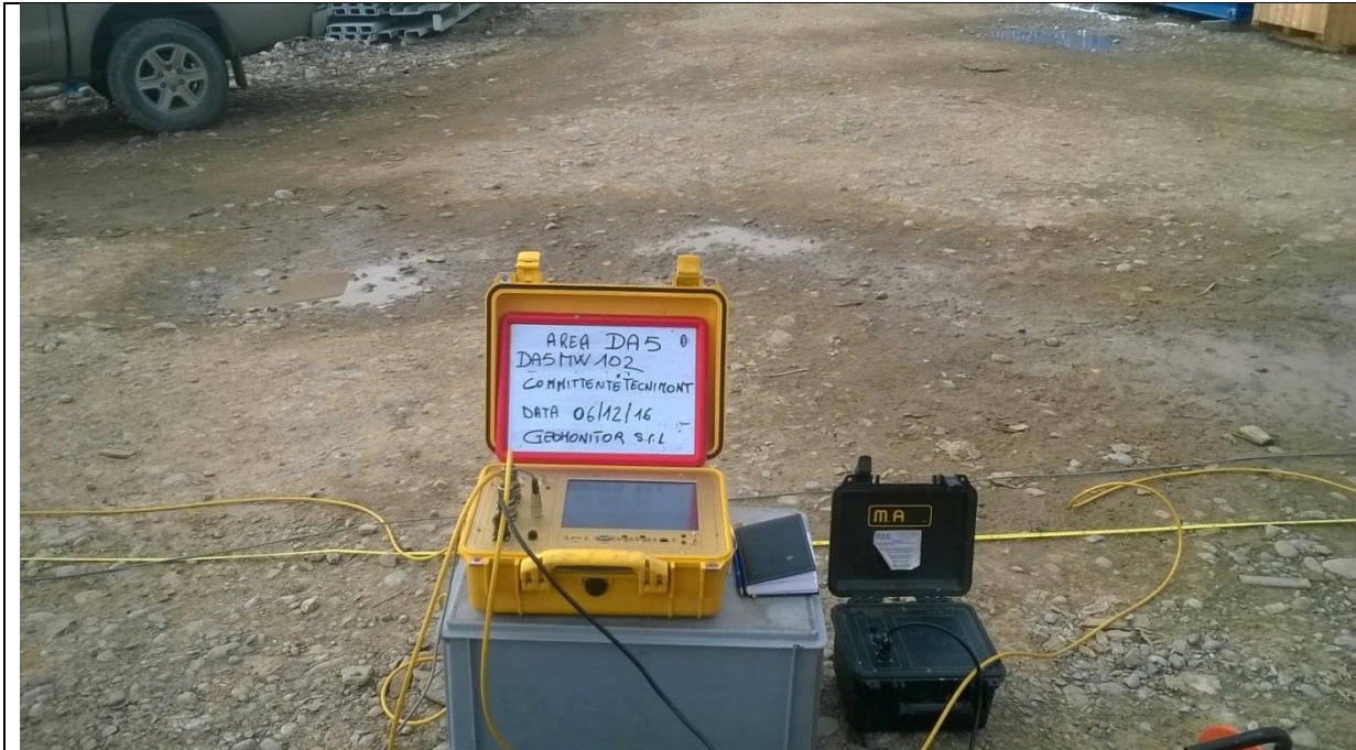
PROSPEZIONE SIMICA MASW MW102
