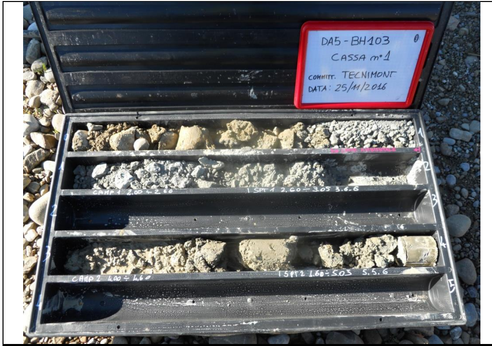
SONDAGGIO BH 103PZ: da m. 0.00 a m. 5.00
