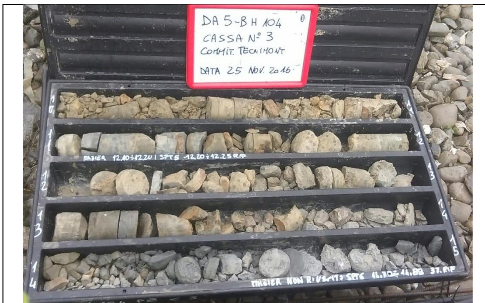
SONDAGGIO BH 104PZ: da m. 15.00 a m. 20.00
