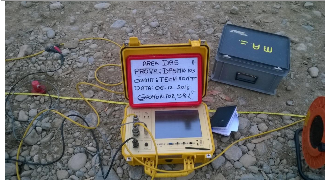
PROSPEZIONE SIMICA MASW MW103
