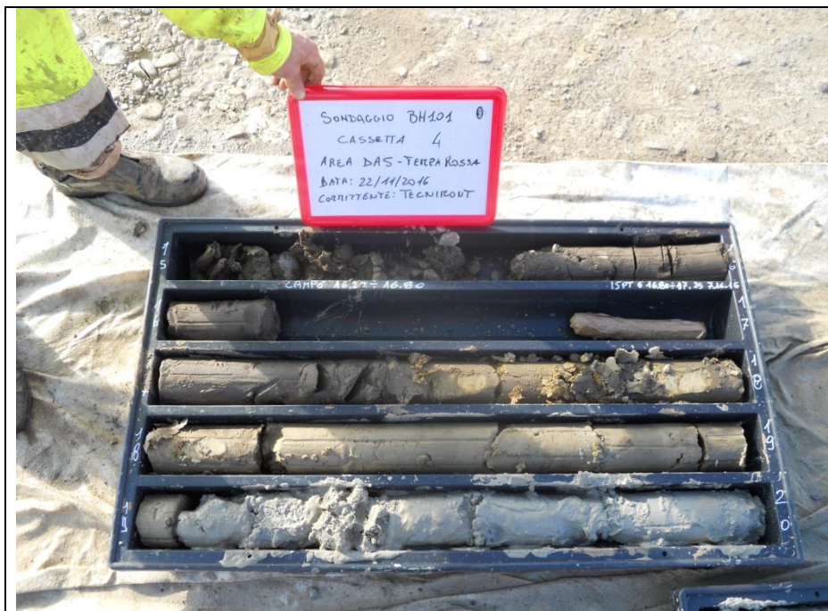
SONDAGGIO BH 101PZ: da m. 15.00 a m. 20.00
