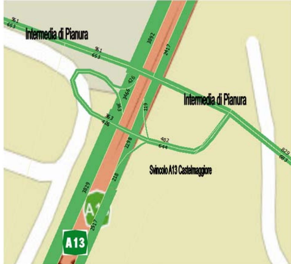
Diagramma di flusso al nuovo svincolo di Castel Maggiore [Veicoli totali] OdP Progettuale 2025
