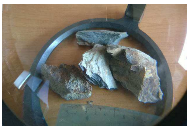
Foto 13 – Alcuni campioni di litotipi arenacei e conglomeratici analizzati in sito e in laboratorio
