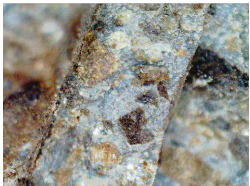
Foto 14 – Immagini al microscopio stereoscopico della superficie fresca dei campioni di arenaria e di breccia.
