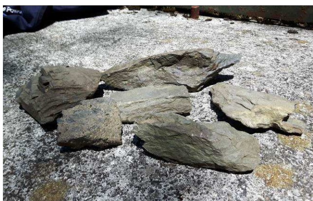
Foto 13 – Alcuni campioni di litotipi arenacei e conglomeratici analizzati in sito e in laboratorio
