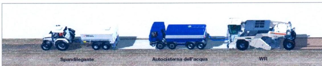
Figura 11.1 - Treno macchine operatrici per realizzazione misto cementato in opera
