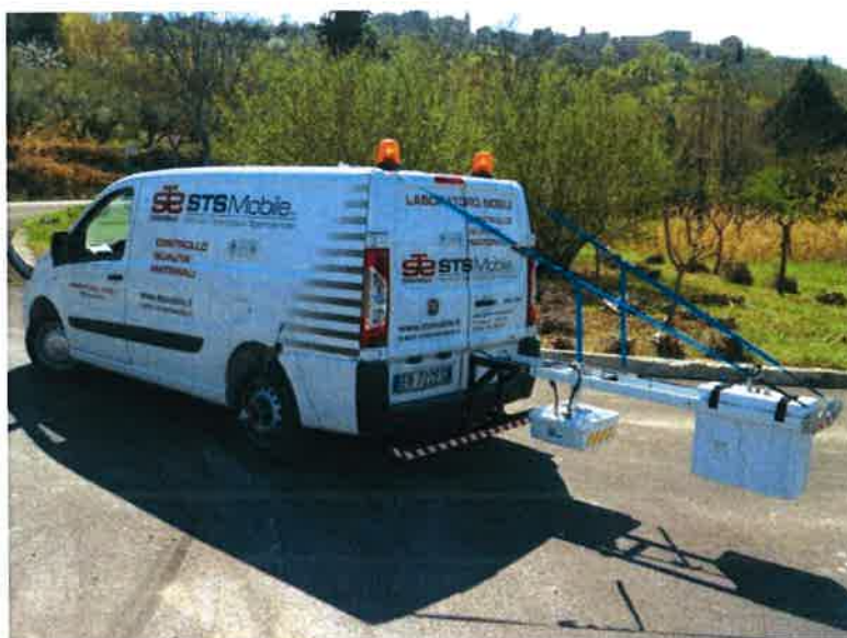
Figura 1. Apparecchiatura RIS HI-PAVE in fase di rilievo
