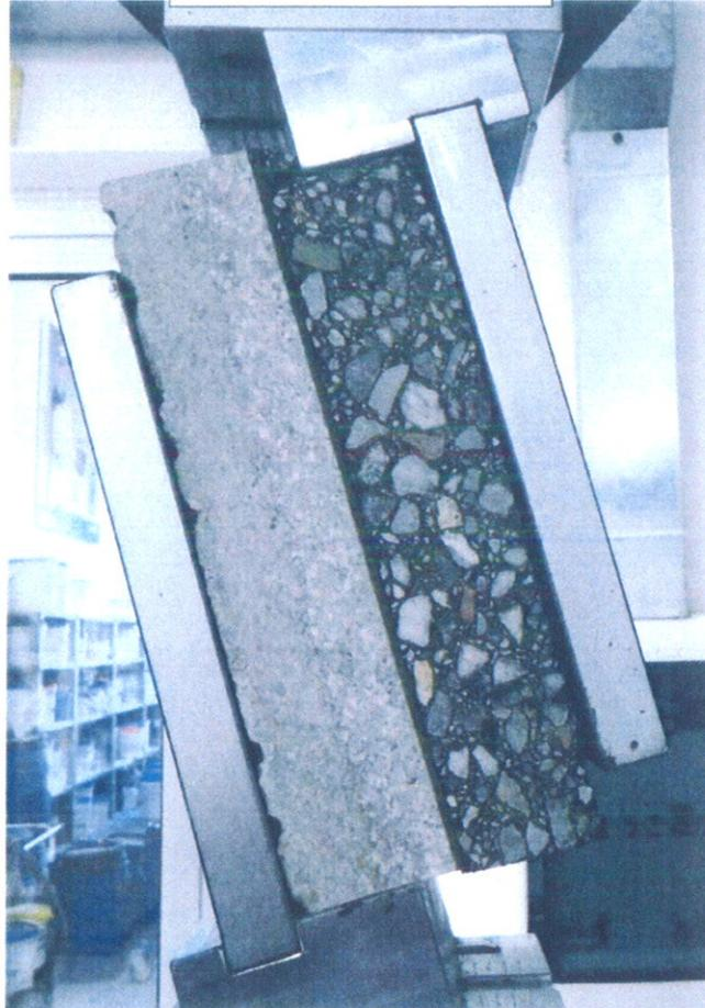
**MAPELASTIC + STYRELF 15 TO (dopo la prova di taglio)**
