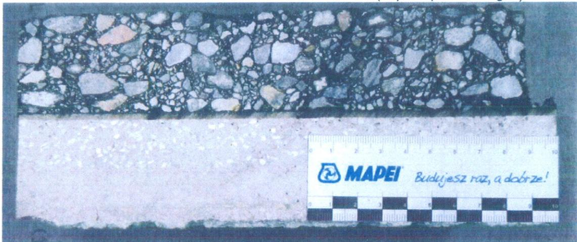
**MAPELASTIC TURBO + STYRELF 15 TO (dopo la prova di taglio)**
