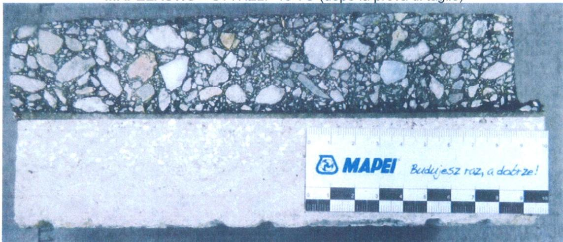
**MAPELASTIC FOUNDATION + STYRELF 15 TO (dopo la prova di taglio)**
