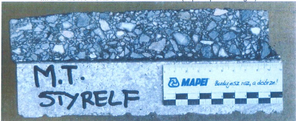
**MAPELASTIC TURBO + bitume 50/70 (dopo la prova di taglio)**
