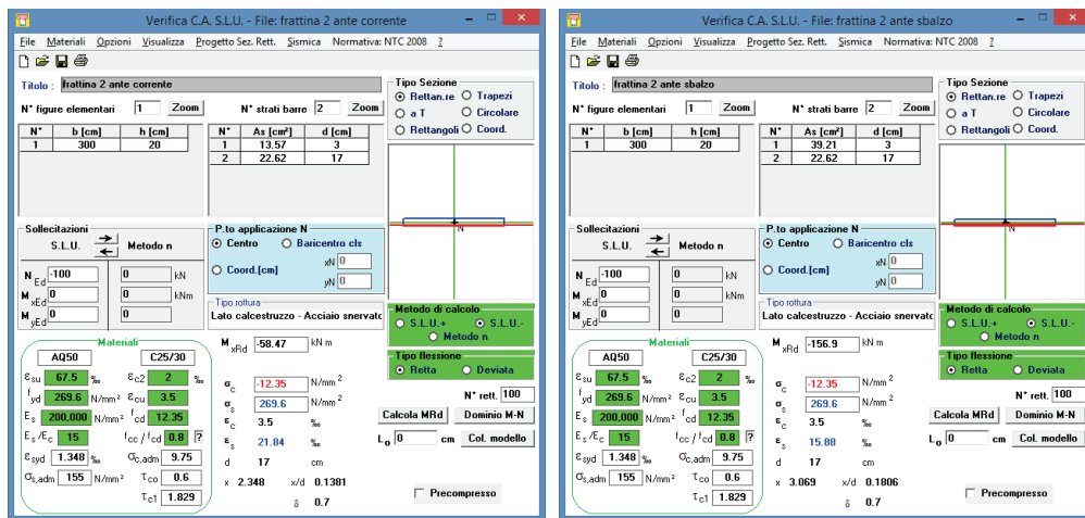
Figura 11 - momenti resistenti nella sezione corrente (immagine a sx) e sullo sbalzo (immagine a dx) della soletta - stato attuale
