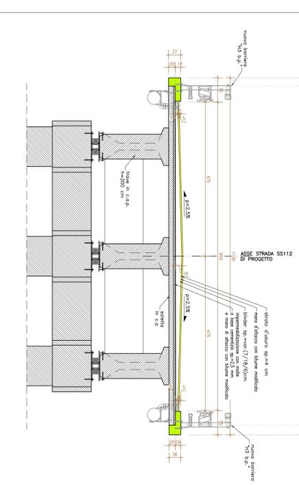
SEZIONE SPALLA 2 (pr.14811.03) scala 1:50
