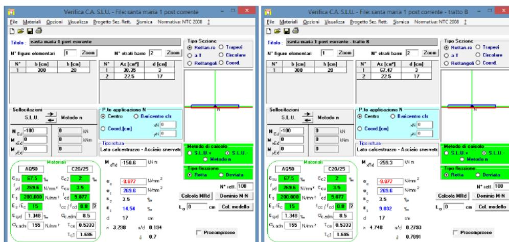
Figura 12 - momenti resistenti nella sezione corrente della soletta con armatura aggiuntiva (acciaio B450C) costituita da  $\Phi 16/30$  cm (immagine a sx) e da  $\Phi 16/15$  cm (immagine a dx) - post intervento
