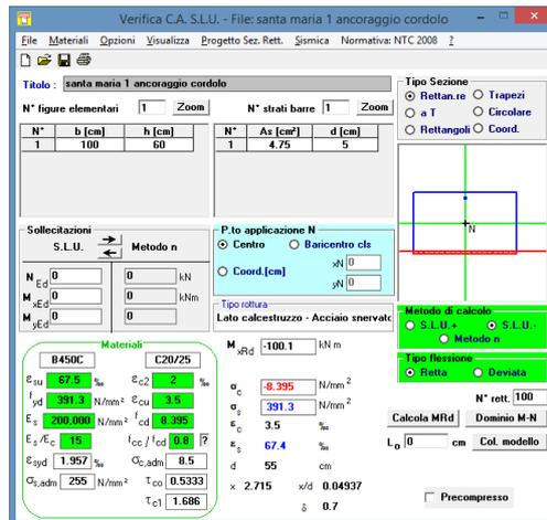
Figura 14 - momento resistente sezione del cordolo
