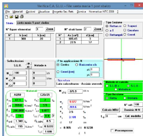
Figura 13 - momento resistente nelle sezioni di sbalzo della soletta con armatura aggiuntiva (acciaio B450C) costituita da  $\Phi 16/15$  cm - post intervento
