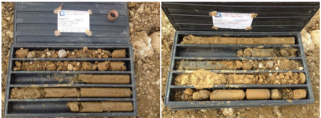
Stratigrafia riscontrata nel sondaggio eseguito a CC
