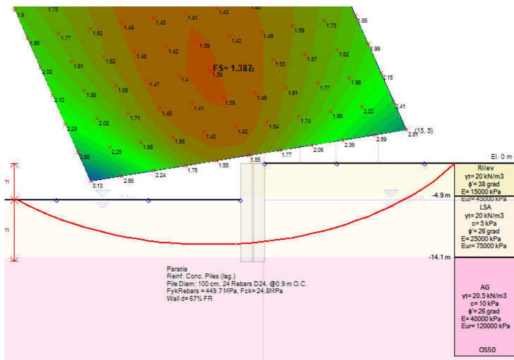
Figura 29 Verifica in condizione sismica – superfici analizzate e superficie critica
