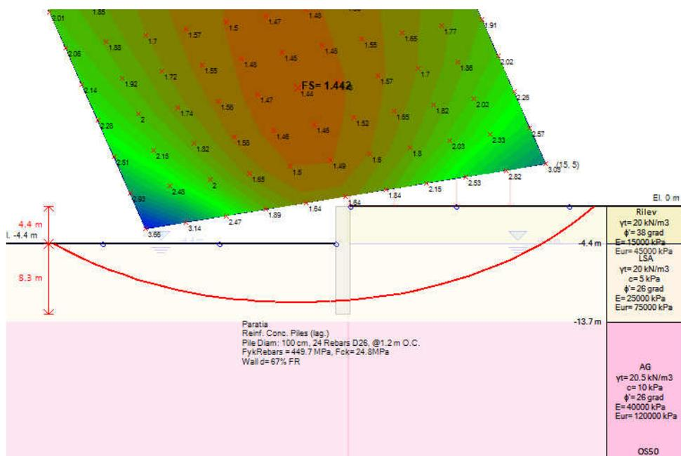
Figura 43 Verifica in condizione sismica – superfici analizzate e superficie critica
