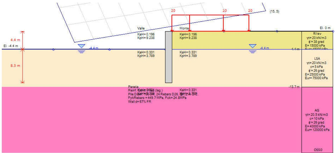
Figura 30 Modello di calcolo – step finale di calcolo
