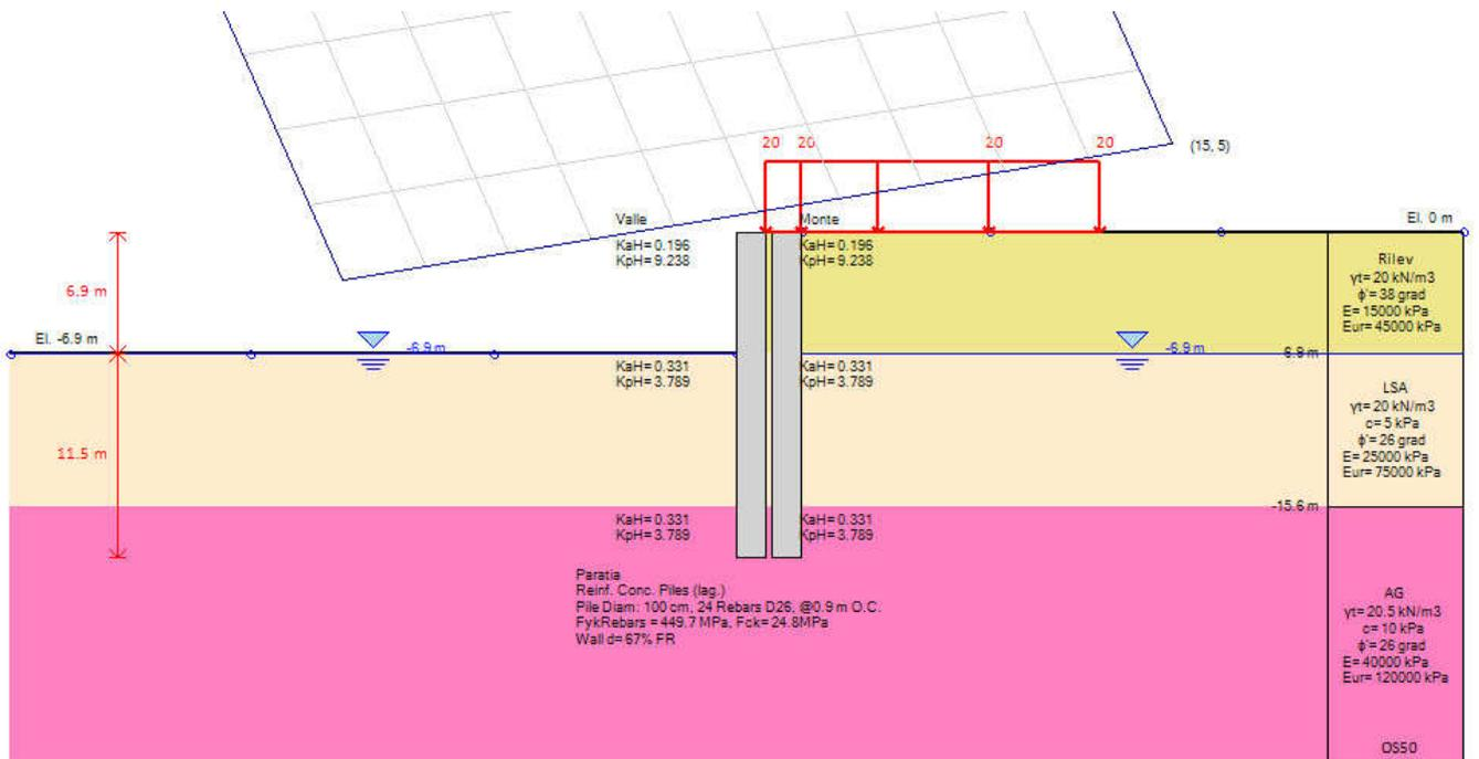
Figura 2 Modello di calcolo – step finale di calcolo
