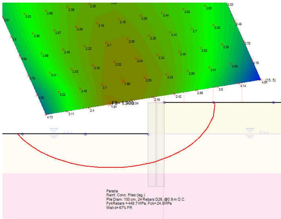
Figura 14 Verifica in condizione statica – superfici analizzate e superficie critica
