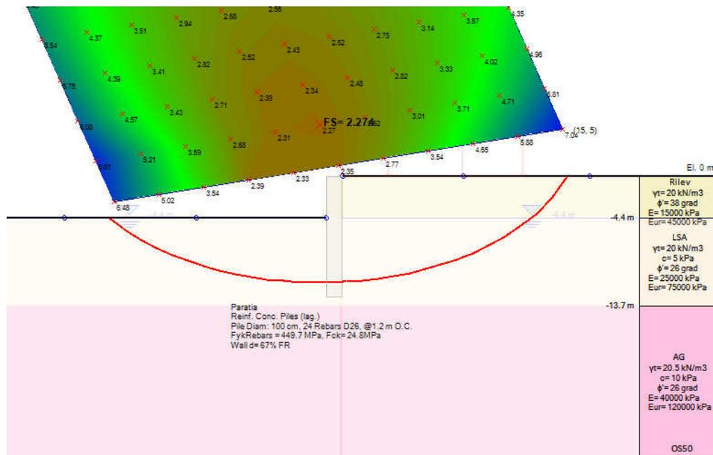
Figura 42 Verifica in condizione statica – superfici analizzate e superficie critica
