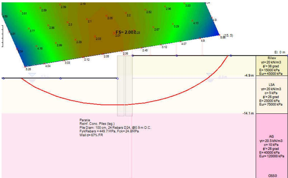
Figura 28 Verifica in condizione statica – superfici analizzate e superficie critica
