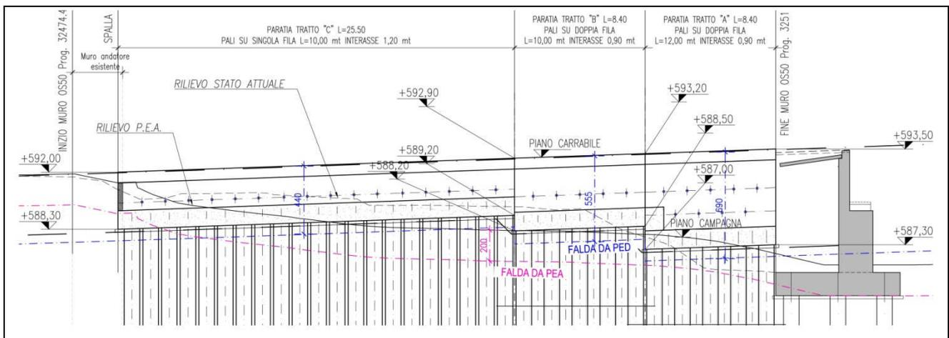
Figura 1 - Prospetto dell'opera con riportati i livelli di falda assunti a base di calcolo in fase di PEA e di PED
