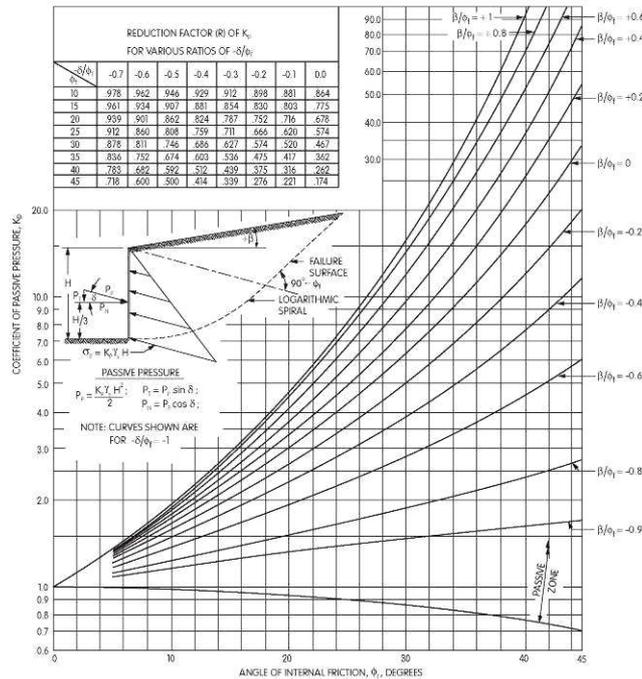
Figura 7.a – Calcolo dei coefficienti di spinta
