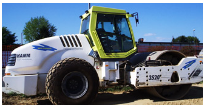
2. Costipamento della miscela terreno-legante (Compattazione).
