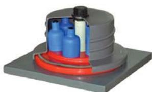
Cap corto con guarnizione su ancoraggio non ritesabile e ancoraggio con protezioni elementari.
