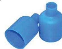
I Copri bussola tipo **DD0015-CV** sono realizzati in H.D.P.E. per proteggere i singoli ancoraggi T15 dalla corrosione. L'ancoraggio deve essere cosparso manualmente di grasso e in seguito ricoperto con la cuffia **DD0015-CV**. Il trefolo porgente è protetto da un tubetto in polietilene 16x20 mm tagliato a misura.
