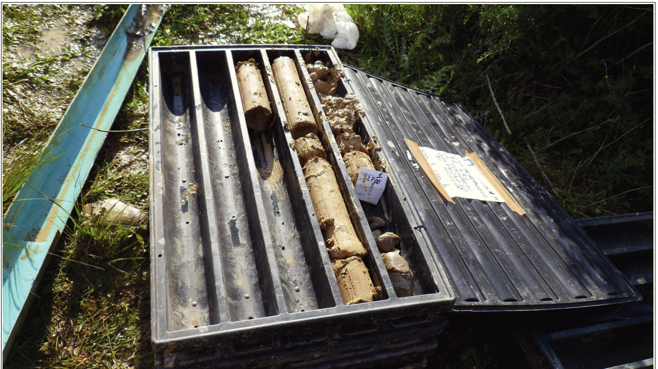
Fig. 3 – Sondaggio geognostico a carotaggio continuo; livelli argillosi a fine sondaggio.
