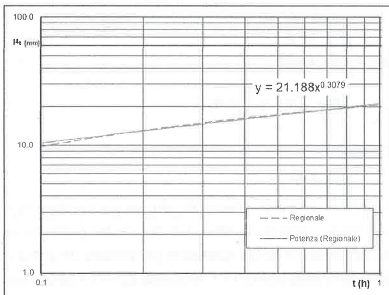
L'espressione del coefficiente udometrico utilizzata nel nostro studio è:
