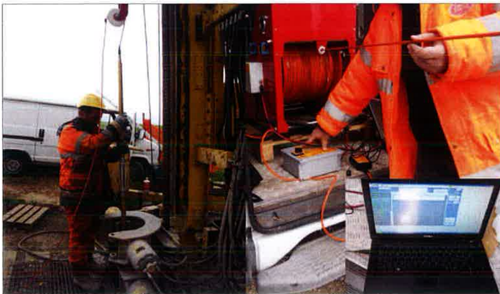
Figura 4: Rilievo della verticalità del foro G6.
