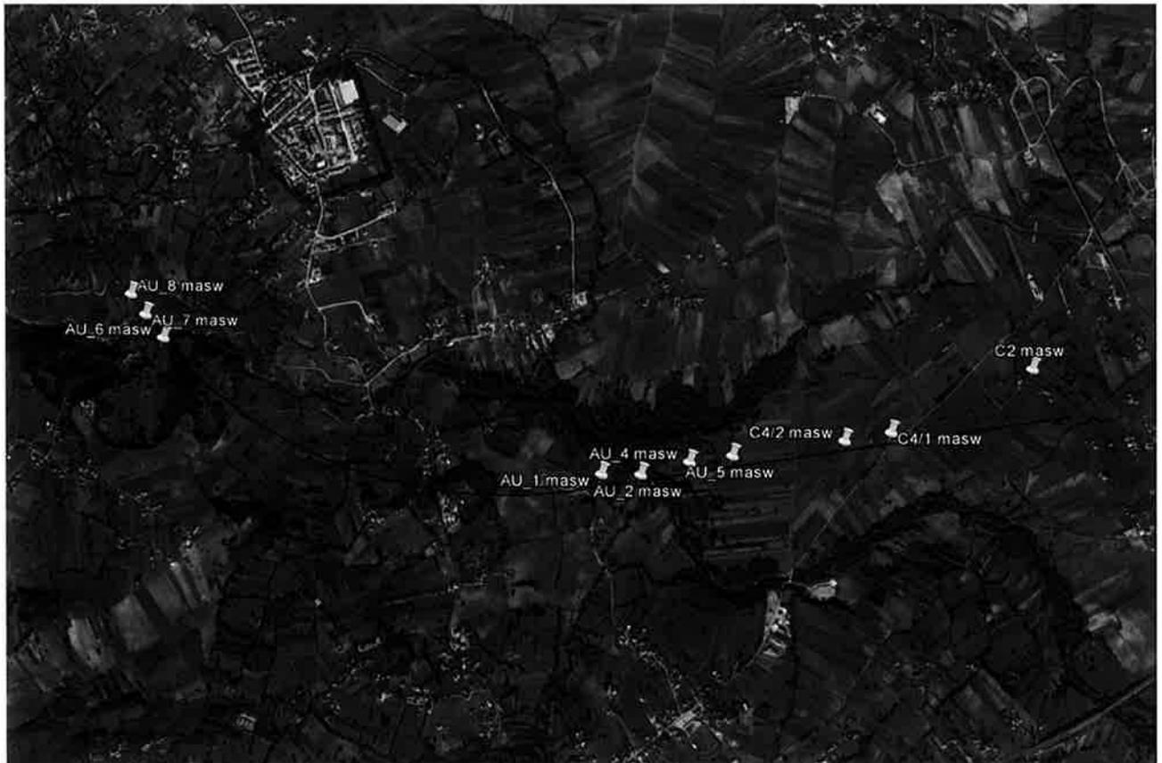
**Fig.5.2c** – Planimetria delle indagini MASW; terzo tratto a Sud-Est.
