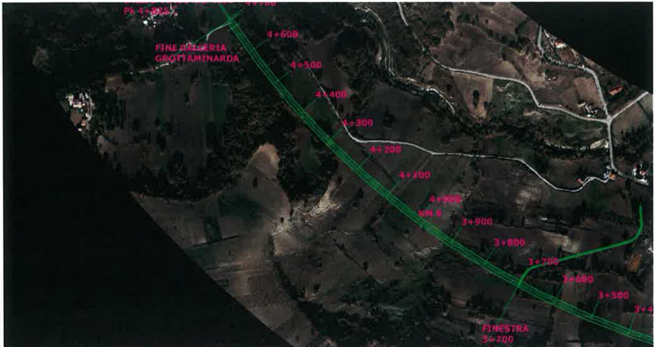
Figura 25. Ortofoto del tratto di galleria Grottaminarda compresa tra le pk 3+400 e l'imbocco lato Napoli
