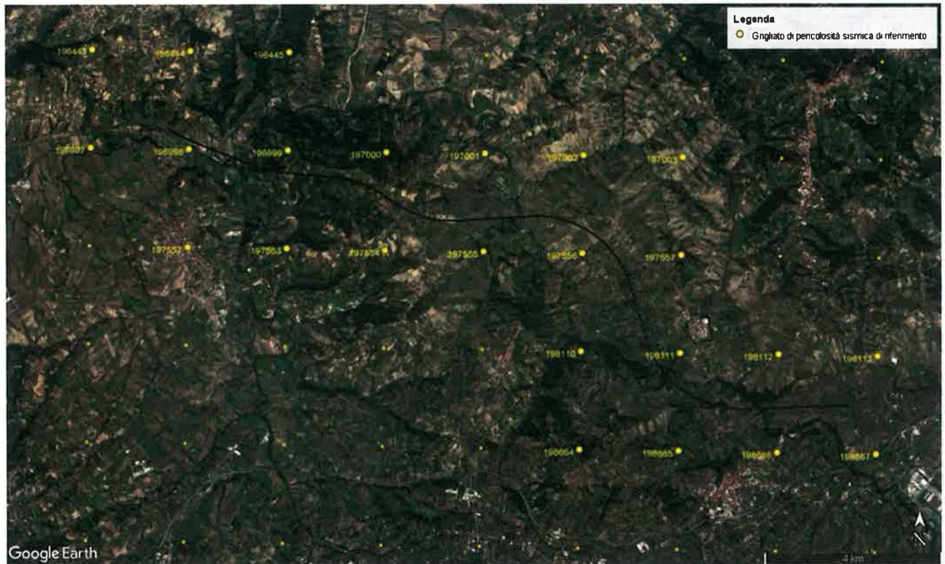
Figura 82. Griglia di riferimento (passo 0.02°) per il settore oggetto di studio, con individuazione del tracciato di progetto (in nero) e dei punti del grigliato entro cui è ricompreso il tracciato (in giallo).
