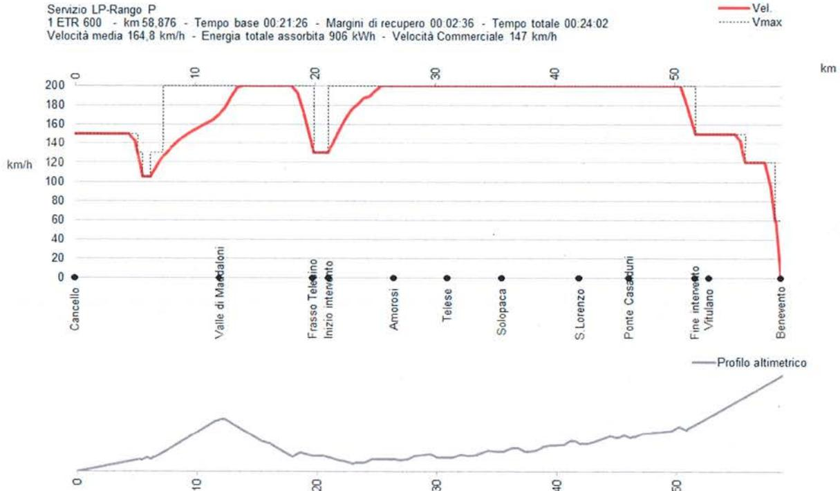
Figura 7: Diagramma spazio-velocità per il servizio Lunga percorrenza con ETR600, nel senso di marcia Cancellò-Benevento.
