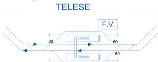
Figura 3 Configurazione di progetto della nuova stazione di Telese
