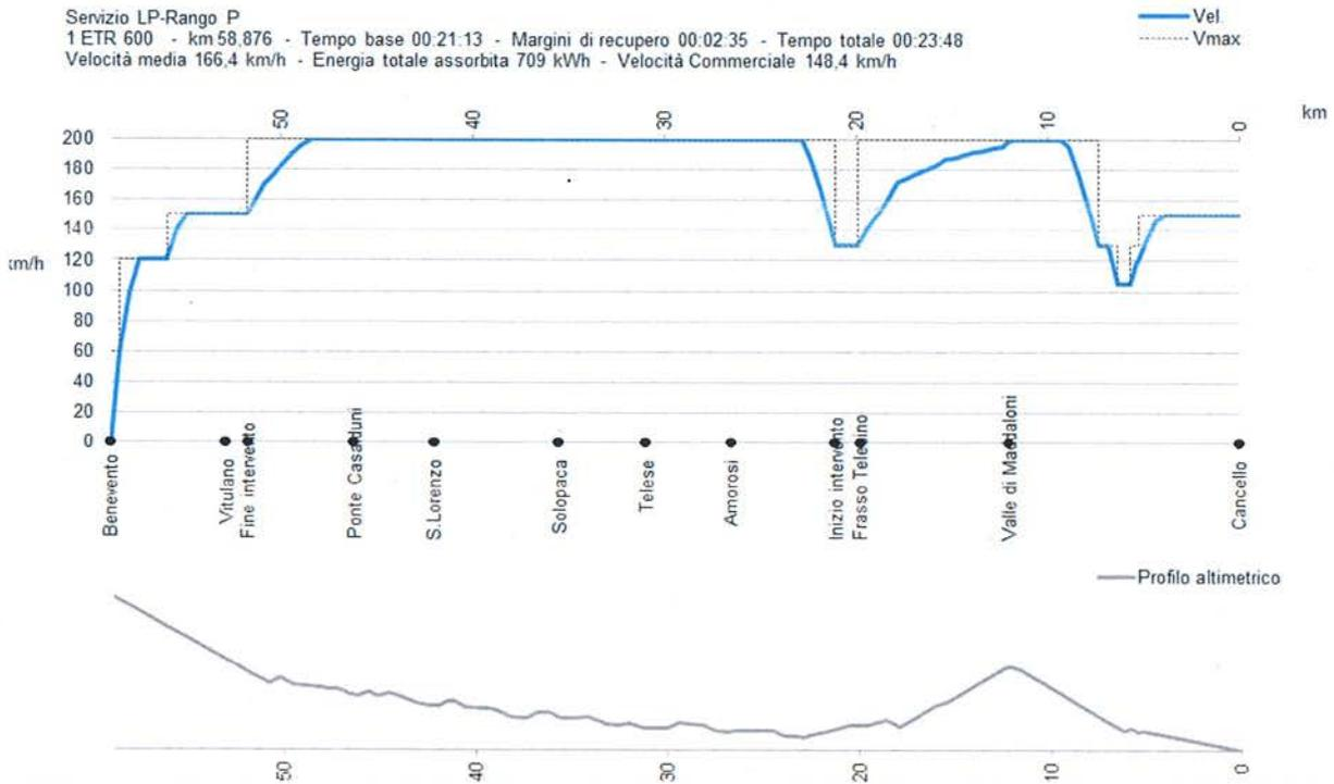
Figura 8: Diagramma spazio-velocità per il servizio Lunga percorrenza con ETR600, nel senso di marcia Benevento-Cancellò.
