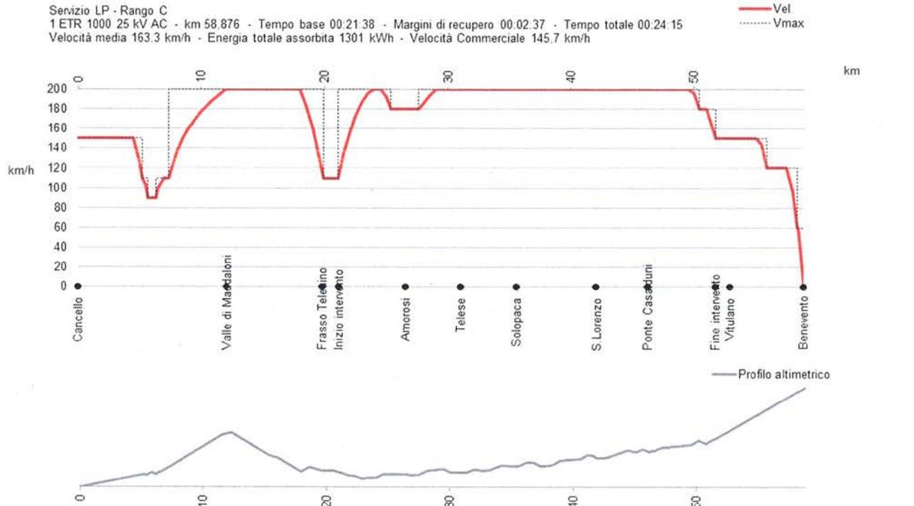
Figura 5: Diagramma spazio-velocità per il servizio Lunga percorrenza con ETR1000, nel senso di marcia Cancellone-Benevento.
