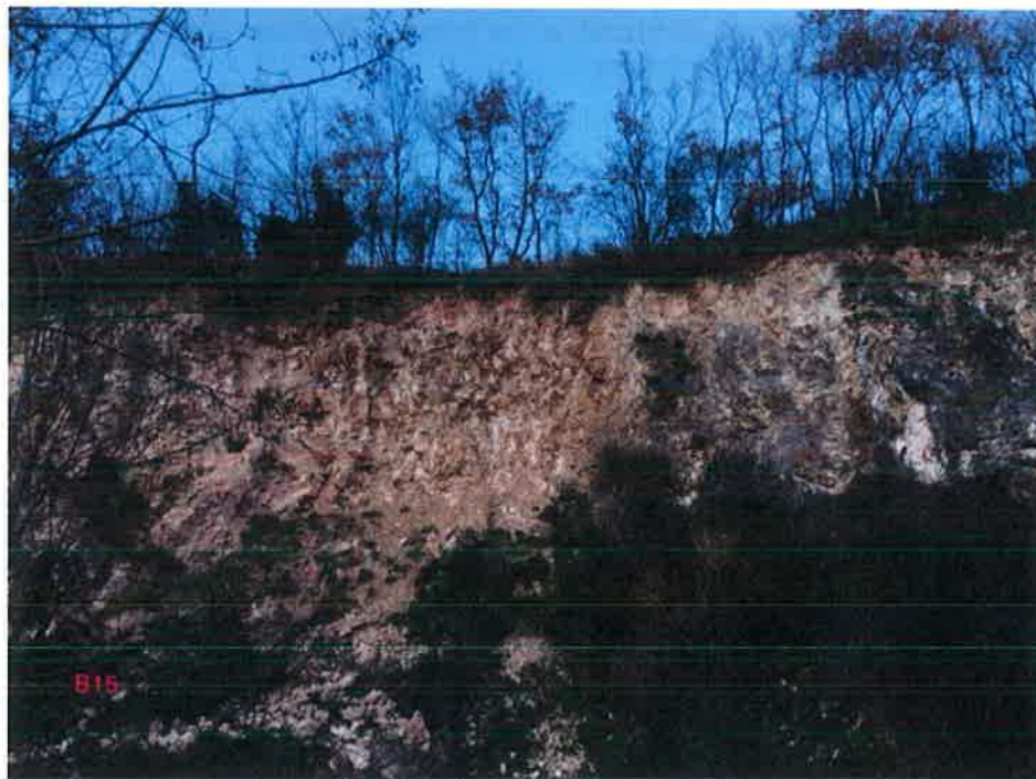
Figura 4 9 – Fenomeni di crollo s.l. che interessano i termini calcareo-marnosi delle Argille Varicolori Superiori.
