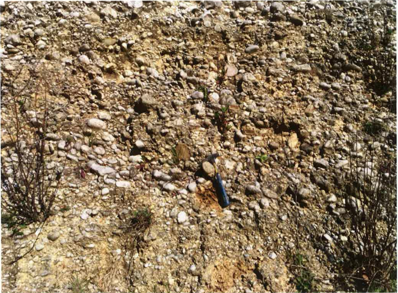
Foto 4 – Affioramenti dei Depositi alluvionali terrazzati ghiaioso-sabbiosi (bn1) mediamente cementati presenti nei pressi della stazione di Solopaca.
