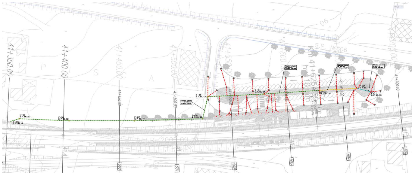
Figura 9: Stazione di Ponte Casalduni, sistema di drenaggio.
