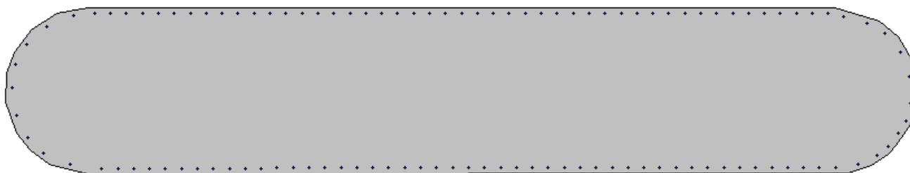
Figura 23 - Sezione trasversale base pila e relativa armatura
