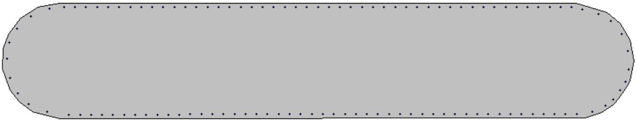
Figura 22 - Sezione trasversale base pila e relativa armatura
