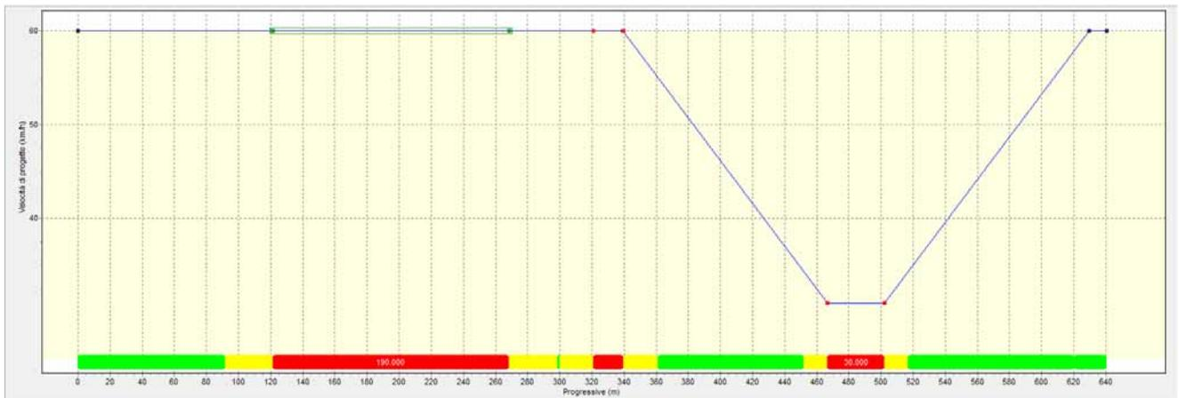
Gli elementi geometrici planimetrici ed altimetrici risultano verificati per un intervallo di velocità di progetto pari a (25 ÷ 50) km/h. Il diagramma corrispondente a tale intervallo è riportato nella figura seguente.
