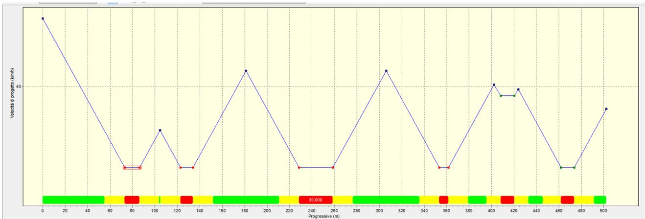
Per il progetto geometrico dell'andamento plano-altimetrico è stato adottato un valore di velocità di progetto pari a 30 km/h. Il diagramma corrispondente a tale velocità è riportato nella figura seguente.
