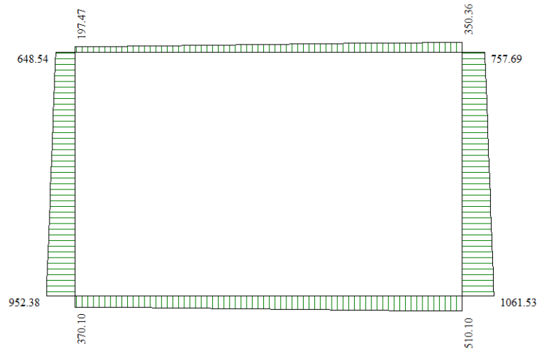
Inviluppo diagrammi dello sforzo normale – SLU statico e sismico
