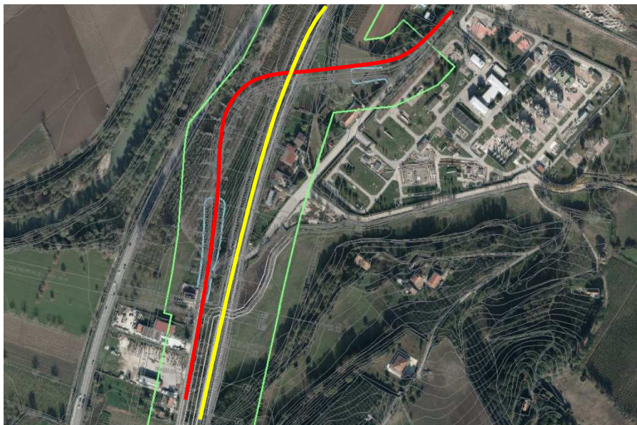
Figura 4-19 – Nuovo cavalcaferrovia, evidenziato in rosso. Il tracciato in progetto è indicato in giallo.
