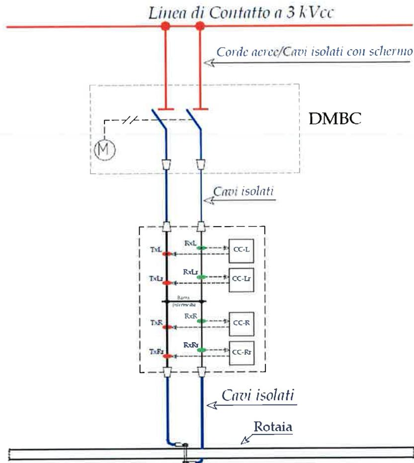
Per consentire il corretto funzionamento del QCC, il DMBC è provvisto di due lame delle medesime caratteristiche. Il DMBC a doppia lama viene collegato tramite due cavi di pari sezione, ed in grado di sostenere l'intera corrente di corto circuito, alla linea di alimentazione (LdC). I punti di collegamento alla linea/feeder devono essere disgiunti in modo che non esista la possibilità di distacco contemporaneo dei cavi dalla linea senza che si interrompa la continuità tra i cavi stessi.
