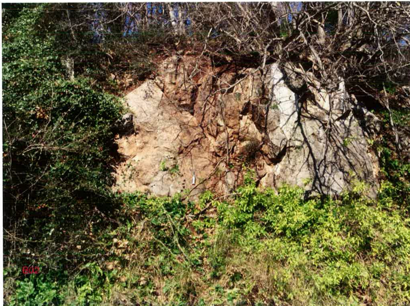
Foto 1 – Litotipi calcareo-dolomiti delle Argille Varicolori Superiori (ALVc) affioranti in corrispondenza della stazione strutturale S03, poco a sud della Galleria Tuoro S. Antuono.
