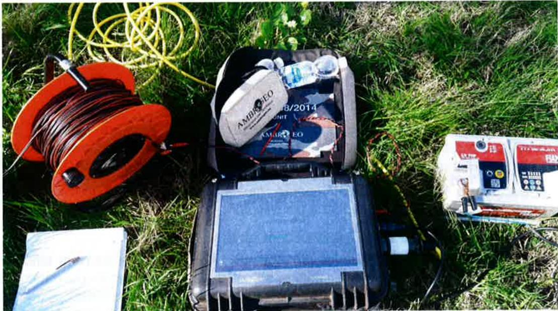
Figura 1: Sismografo digitale a 24 bit.
