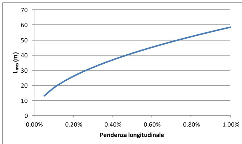
**Fig. 7** – Distanza minima degli scarichi in rilevato
