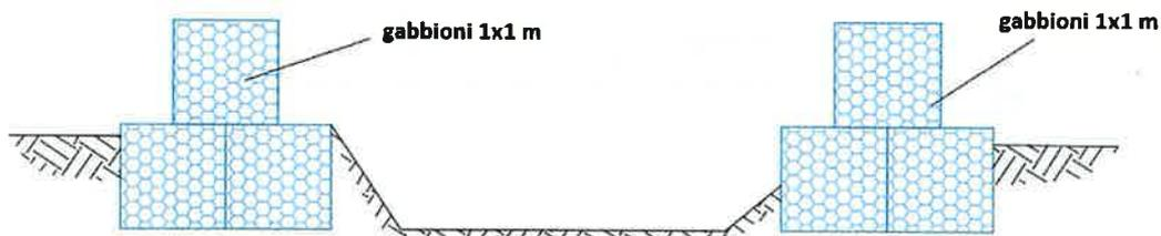
Figura 8: Intervento di rifacimento degli argini - Sezione tipo
