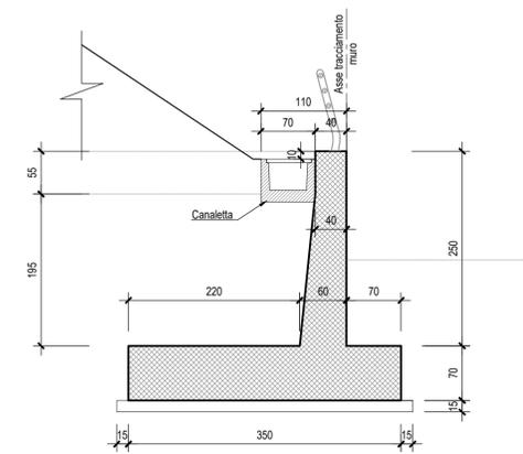
SEZIONE TIPO MURO H-3.00-Scala 1:50
