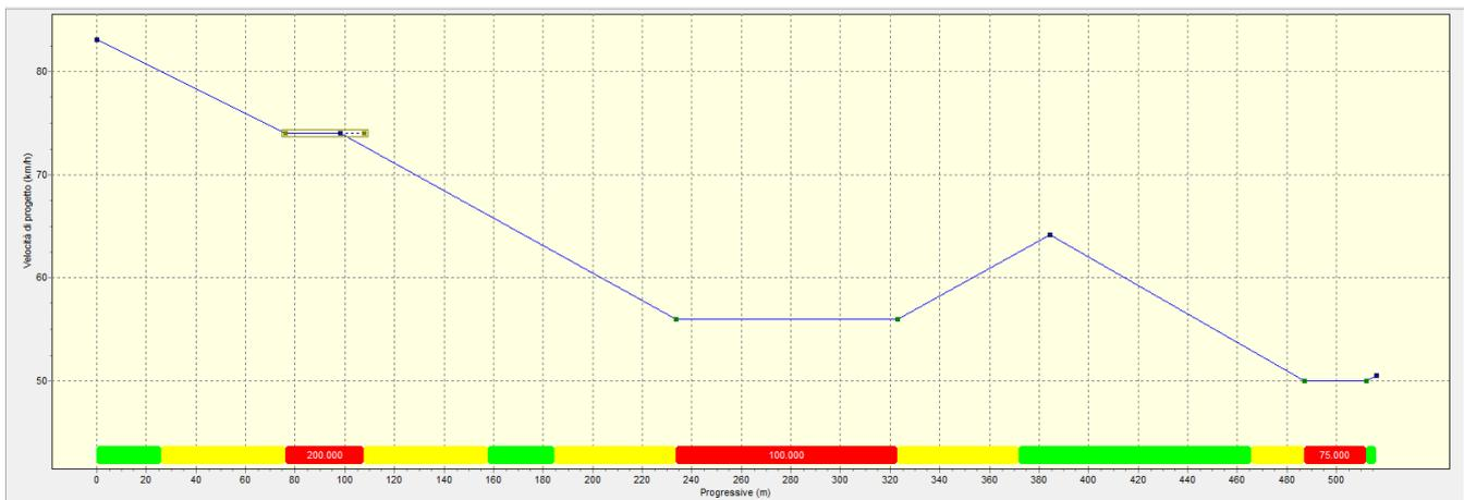
Gli elementi geometrici planimetrici ed altimetrici risultano verificati per un valore di velocità di progetto pari a 40 km/h. Il diagramma corrispondente a tale velocità è riportato nella figura seguente.
