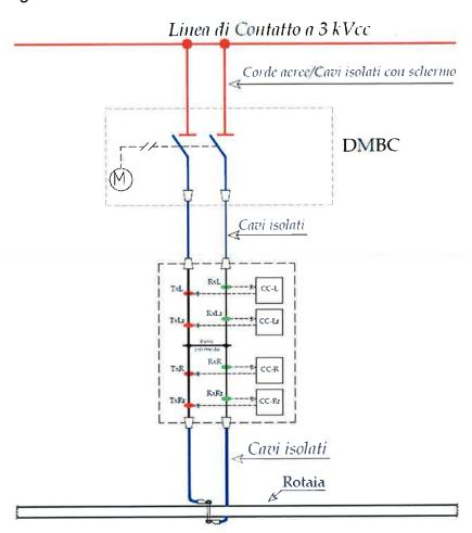
Per consentire il corretto funzionamento del QCC, il DMBC è provvisto di due lame delle medesime caratteristiche. Il DMBC a doppia lama viene collegato tramite due cavi di pari sezione, ed in grado di sostenere l'intera corrente di corto circuito, alla linea di alimentazione (LdC). I punti di collegamento alla linea/feeder devono essere
