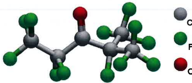
Figura 1: Struttura Chimica del Fluido Novec™ 1230
