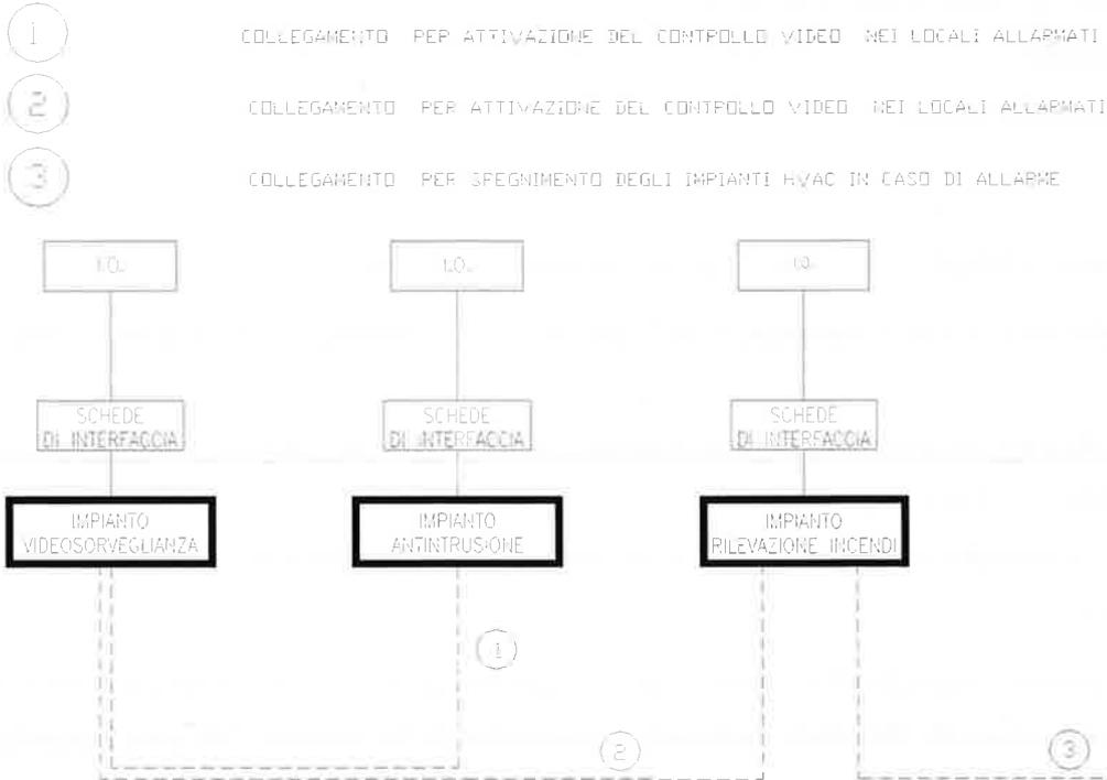
La centrale controllo accessi – antintrusione, inoltre, potrà essere interfacciata con lo switch del sistema di supervisione per la gestione e il controllo remoto.
