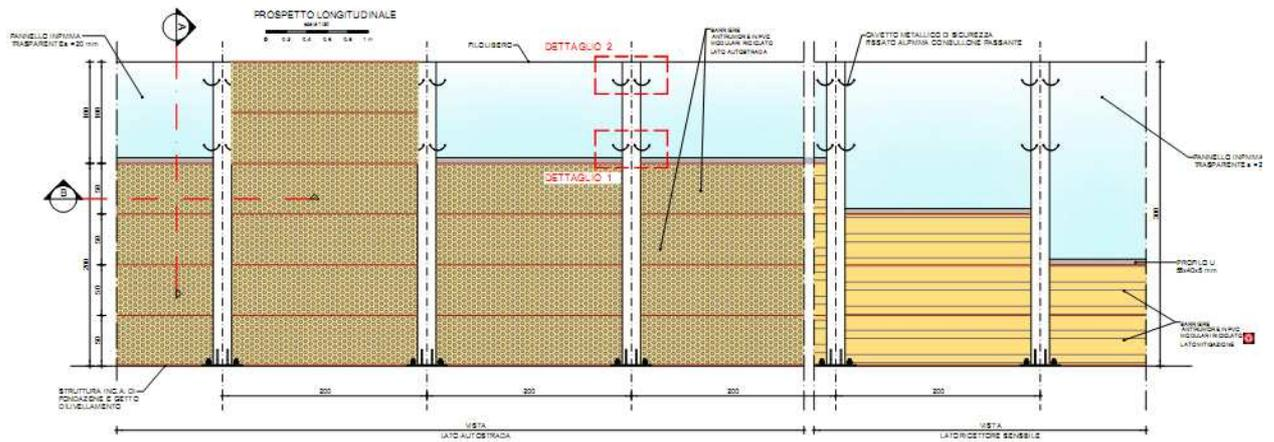
Figura 62: Tipologico barriera antirumore in plastica riciclata e PMMA
