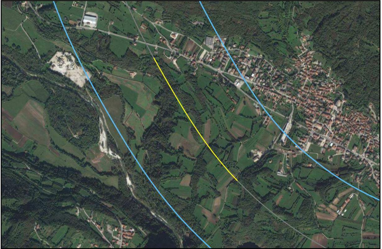
Figura 35: I tratti in trincea e rilevato prima della Galleria Cogollo
