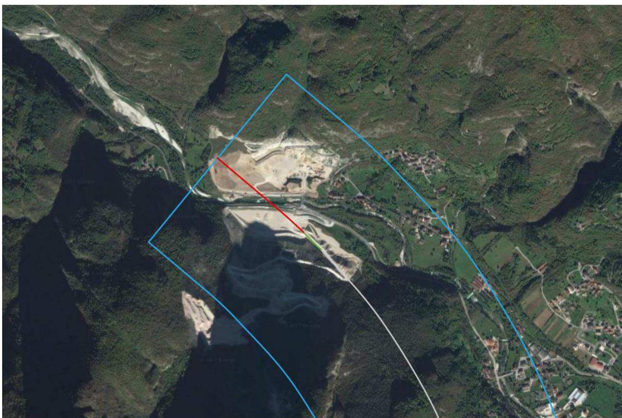
Figura 37: I tratti in viadotto e rilevato del nuovo tracciato prescelto
