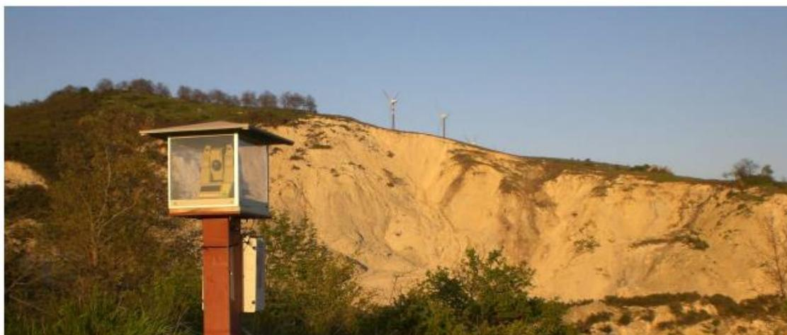
Stazione topografica robotizzata per stazione di monitoraggio installata su un gabbiotto di protezione montato su palo di sostegno
