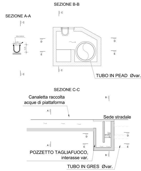
PARTICOLARI POZZETTO DI DRENAGGIO IN GALLERIA DN315
