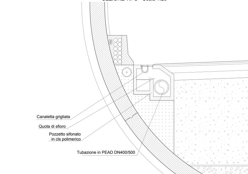
SEZIONE DRENAGGIO IN GALLERIA ARTIFICIALE scala 1:25
