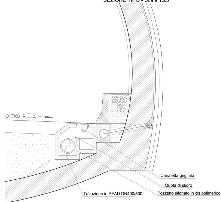
PARTICOLARI POZZETTO DI DRENAGGIO IN GALLERIA DN630
