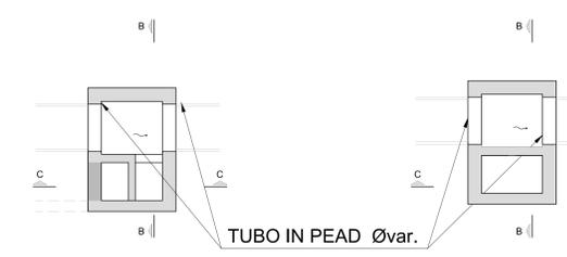
SISTEMA DI DRENAGGIO IN GALLERIA MECCANIZZATA DN400/500- DIREZIONE TRENTO
