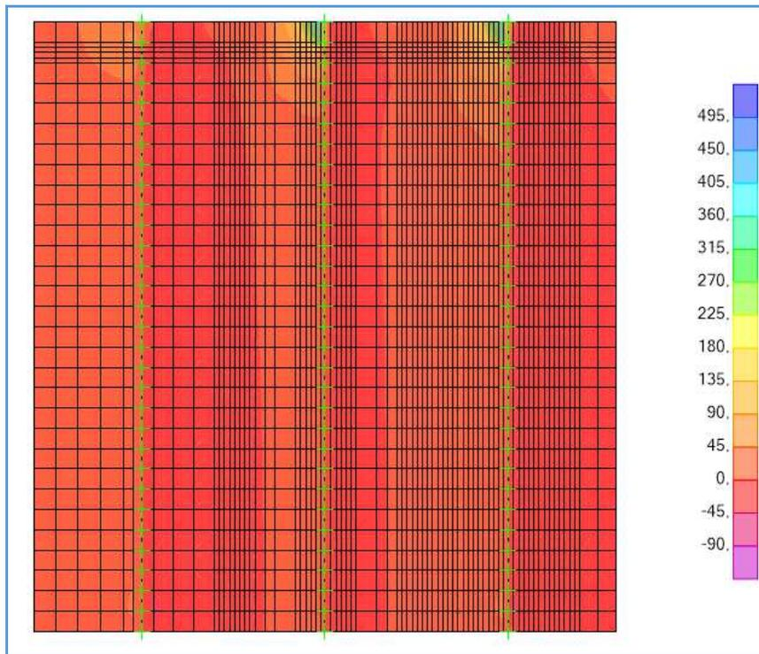
**Schema di carico 2 –  $V_{13,MAX}$  - Involuppo – Bordo soletta**
