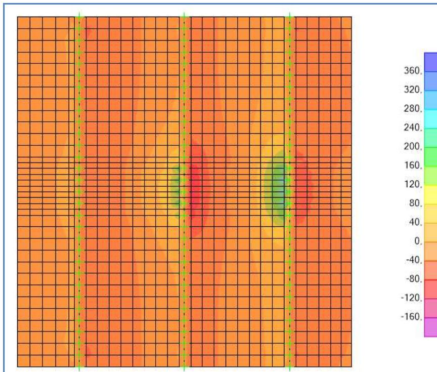
Schema di carico 1 –  $V_{13,MAX}$  - Involuppo – Mezzeria soletta
