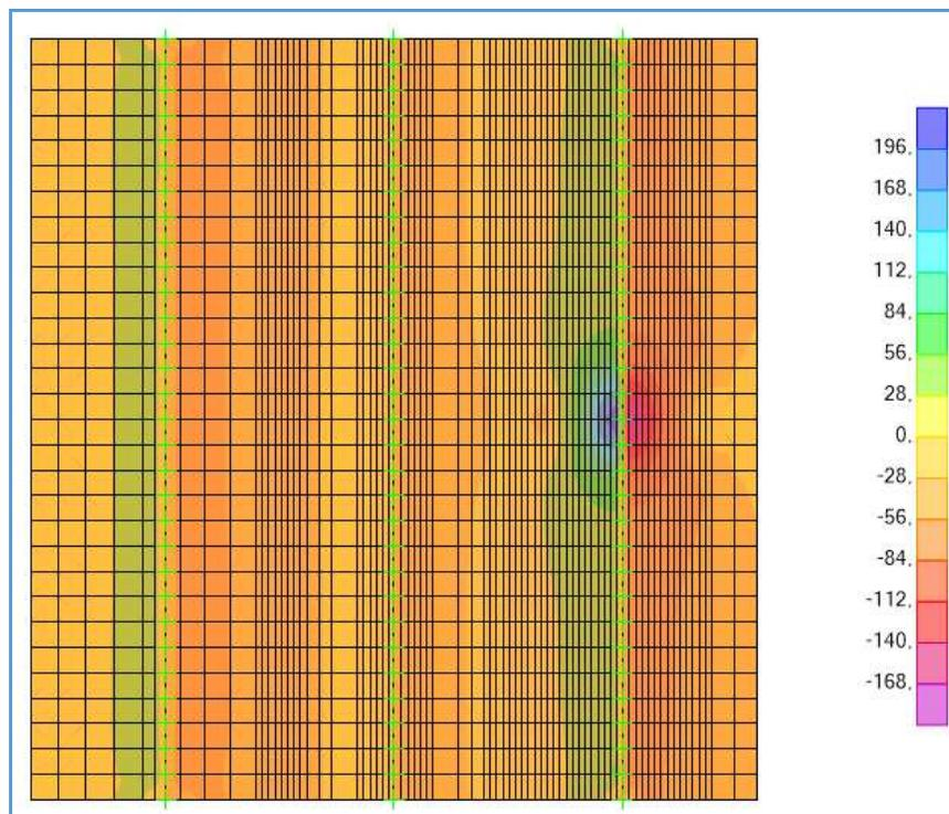
**Schema di carico 2 –  $V_{13,MIN}$  - Inviluppo – Mezzeria soletta**
