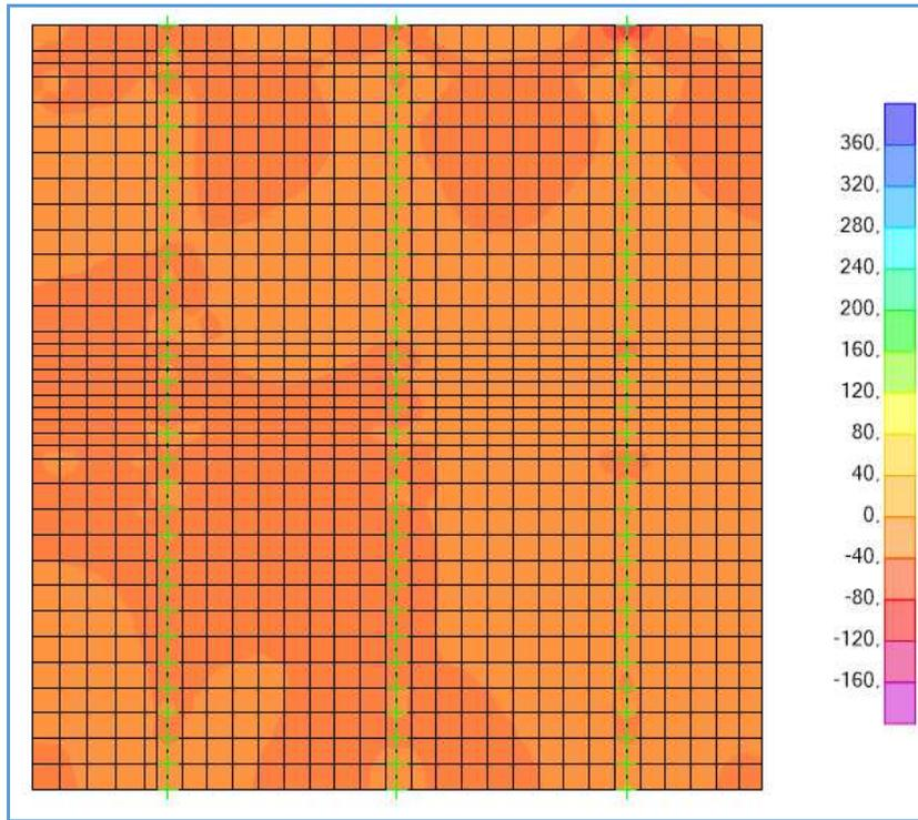
**Schema di carico 1 –  $V_{23,MAX}$  - Inviluppo – Bordo soletta**
