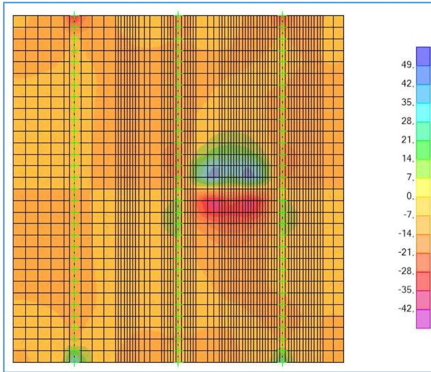
**Schema di carico 2 –  $V_{23,MAX}$  - Involuppo – Mezzeria soletta**
