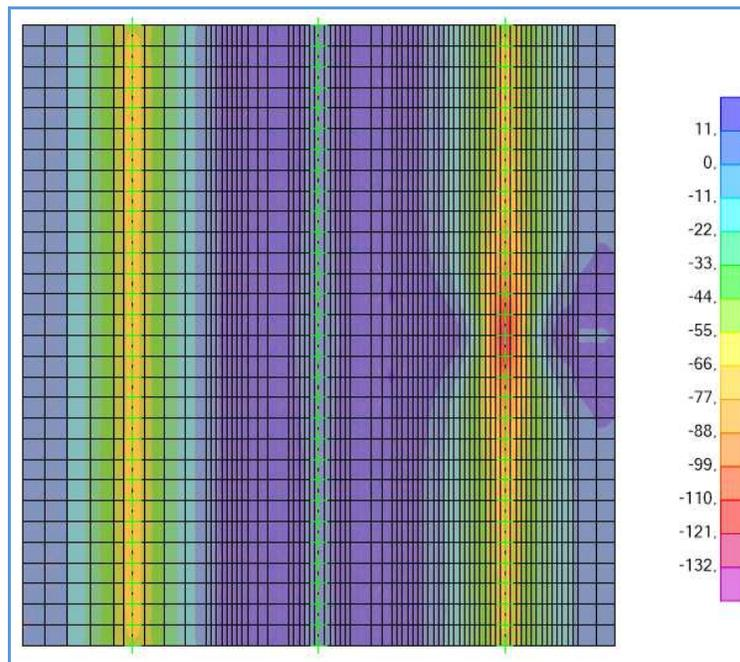
Schema di carico 2 –  $M_{11,MIN}$  - Involuppo – Mezzeria soletta
