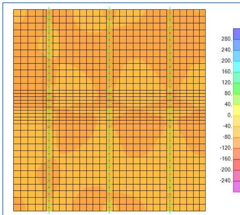
**Schema di carico 1 –  $V_{23,MAX}$  - Involuppo – Mezzeria soletta**
