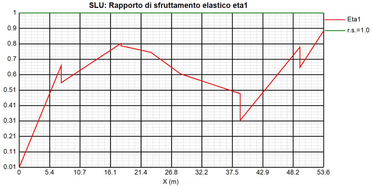
$\eta_1$  per sezioni in classe 3 e 4,  $\bar{\eta}_1$  per sezioni in classe 1 e 2 (Mmax, Mmin, Vmax, Vmin)
