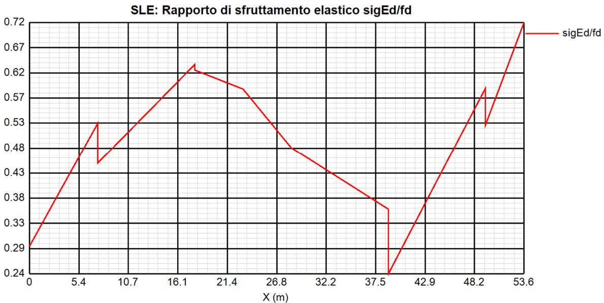
$$\eta_1 = \frac{\sigma_{Ed}}{f_y / \gamma_{Mserv}} \quad \text{rapporto di sfruttamento elastico per tensioni normali}$$
