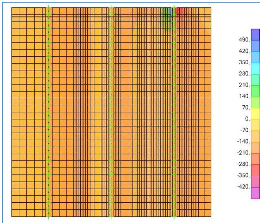
**Schema di carico 2 –  $V_{13,MIN}$  - Involuppo – Bordo soletta**
