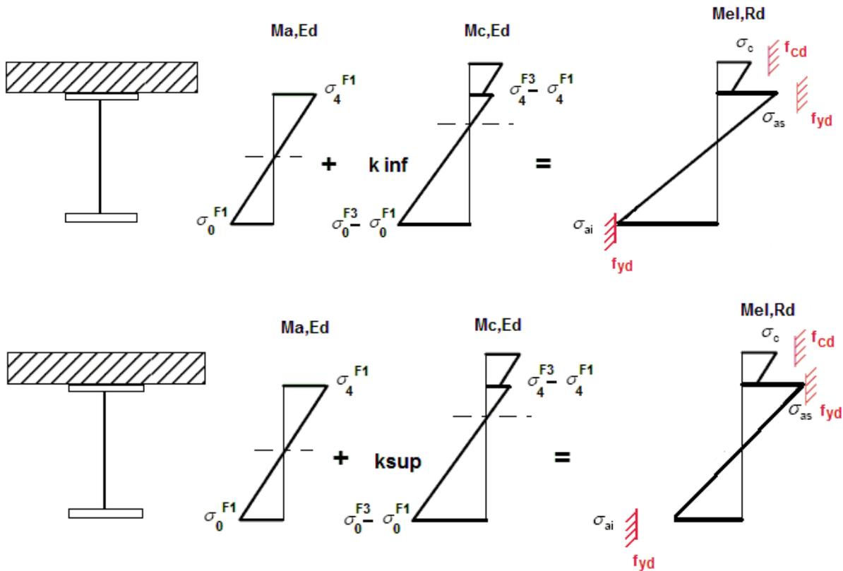
Quando la sezione è plasticizzata il coefficiente  $k$  risulta compreso fra 0 ed 1, e rappresenta il coefficiente moltiplicativo che riporta il diagramma di tensioni in fase 3 ad un diagramma al limite elastico.
