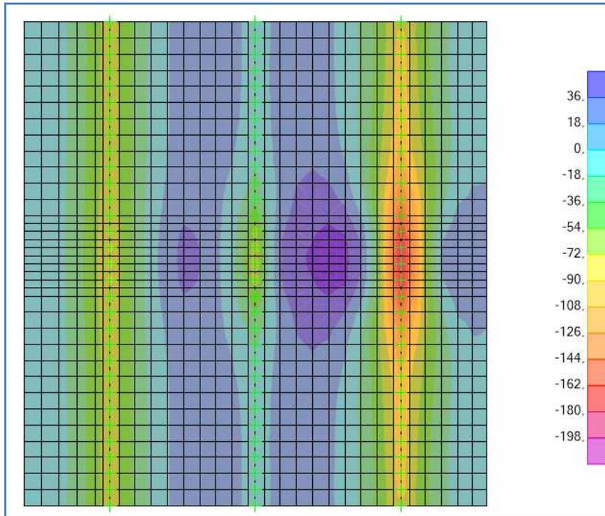
Schema di carico 1 –  $M_{11,MIN}$  - Involuppo – Mezzeria soletta
