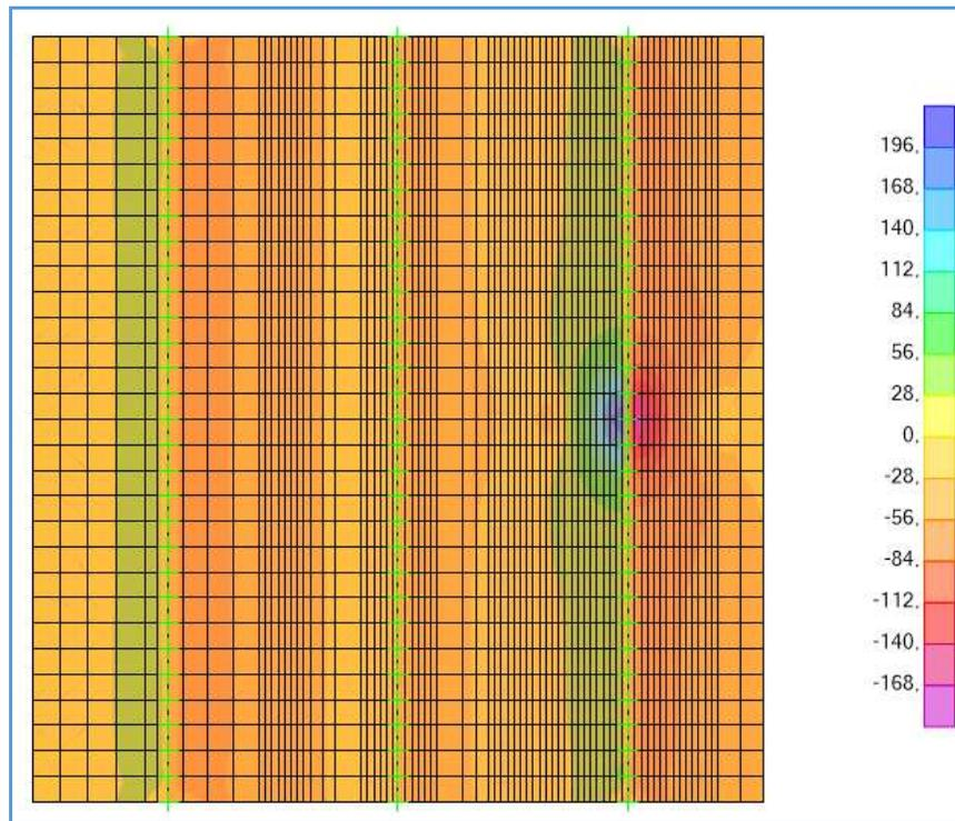
**Schema di carico 2 –  $V_{13,MAX}$  - Inviluppo – Mezzeria soletta**
