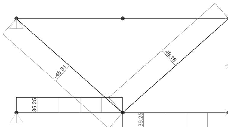
Lo sforzo normale del corrente superiore è pari a :                    36 kN
