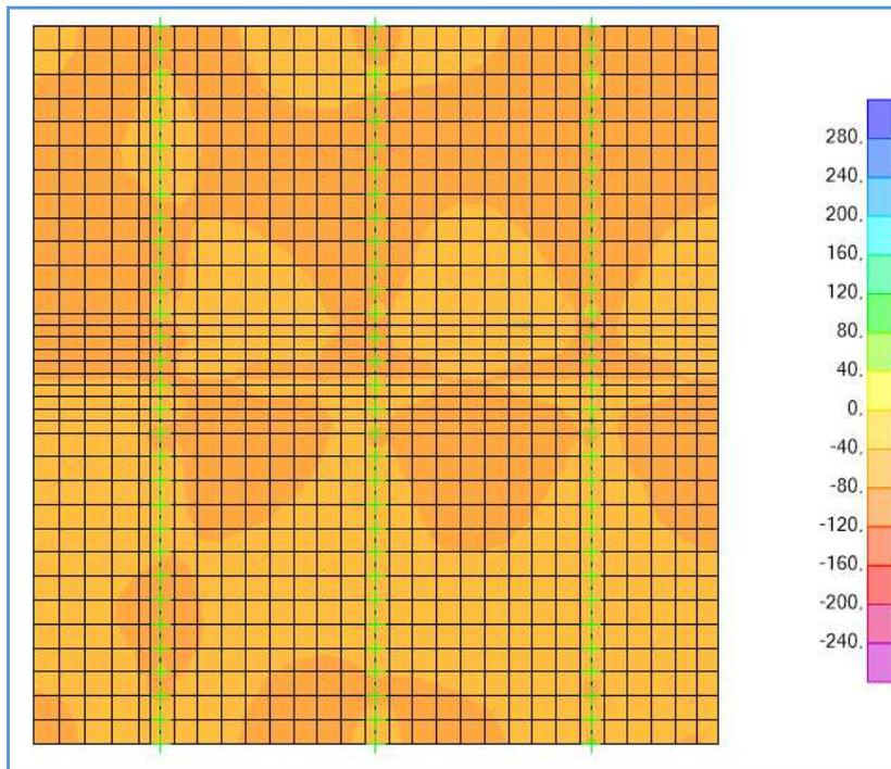
Schema di carico 1 –  $V_{23,MIN}$  - Involuppo – Mezzeria soletta
