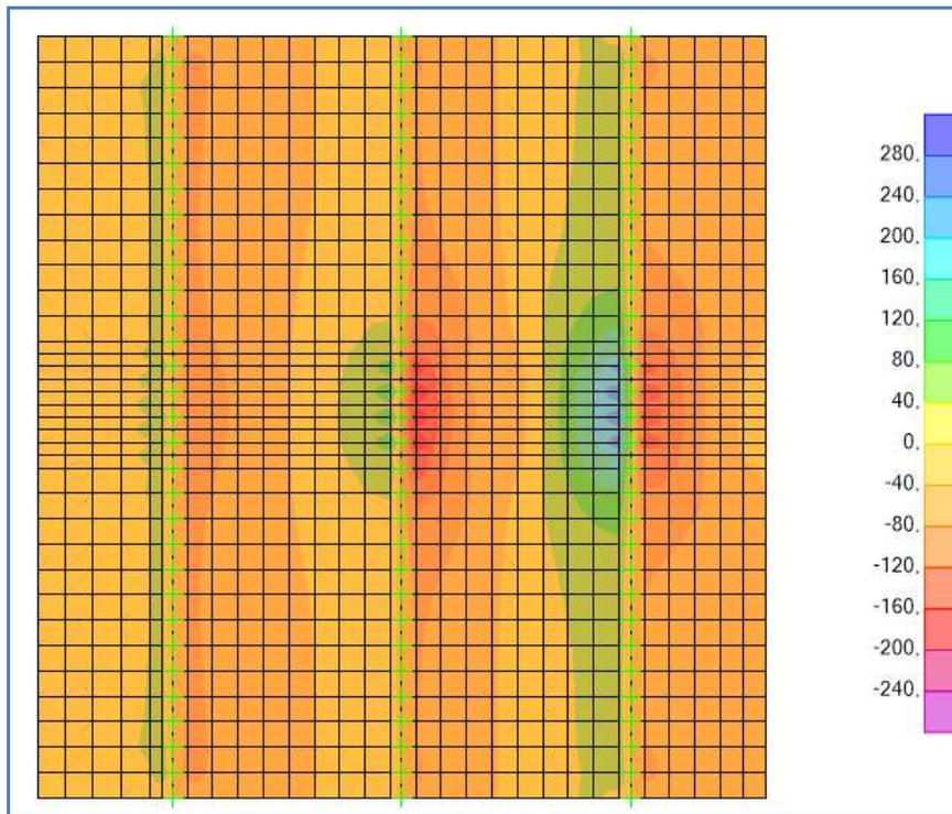
**Schema di carico 1 –  $V_{13,MIN}$  - Involuppo – Mezzeria soletta**
