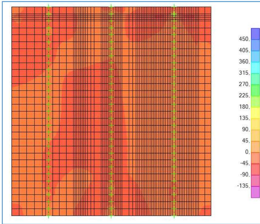
**Schema di carico 2 –  $V_{23,MAX}$  - Involuppo – Bordo soletta**
