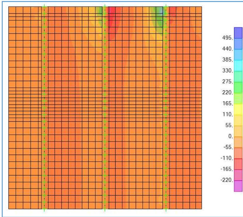
**Schema di carico 1 –  $V_{13,MAX}$  - Involuppo – Bordo soletta**
