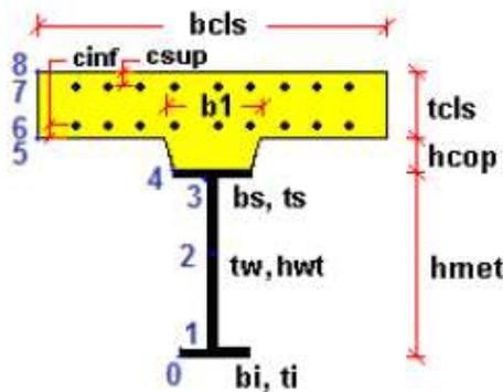
Nell'ambito del calcolo tensionale, la soletta viene considerata "cracked" (non reagente) all'atto dell'annullamento della tensione di compressione valutata in corrispondenza della fibra media. Contestualmente all'annullamento della soletta, si annullano anche le sollecitazioni da ritiro primario.
