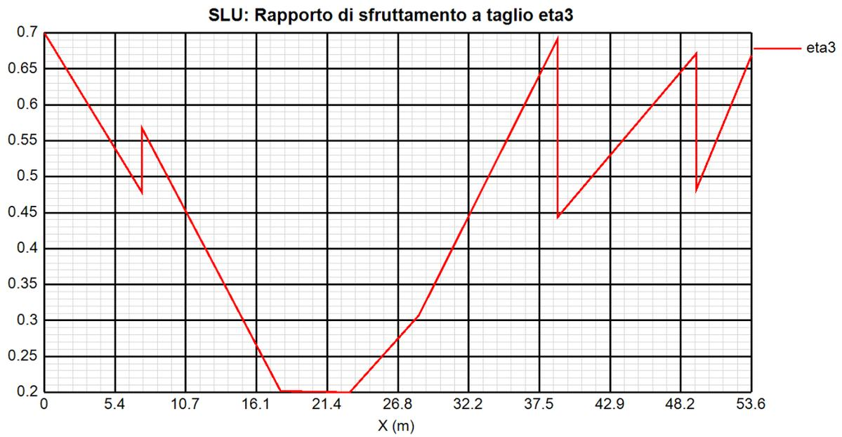
$$\frac{V_{Ed}}{V_{Rd}} \quad \text{rapporto di sfruttamento a taglio}$$
