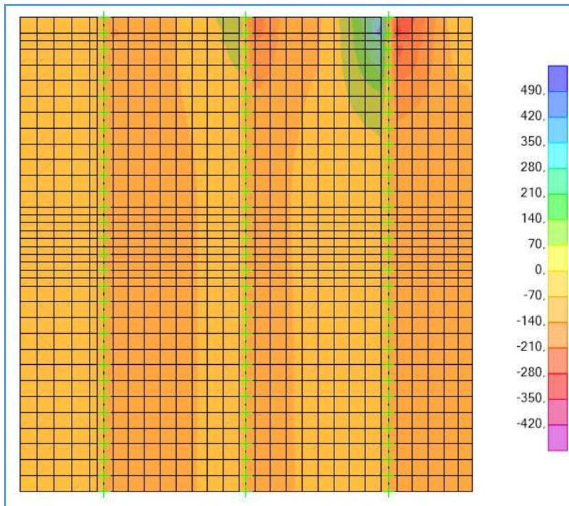
**Schema di carico 1 –  $V_{13,MIN}$  - Involuppo – Bordo soletta**
