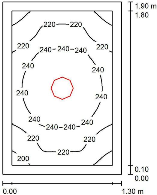
Altezza locale: 3.000 m, Altezza di montaggio: 3.062 m, Fattore di manutenzione: 0.90
