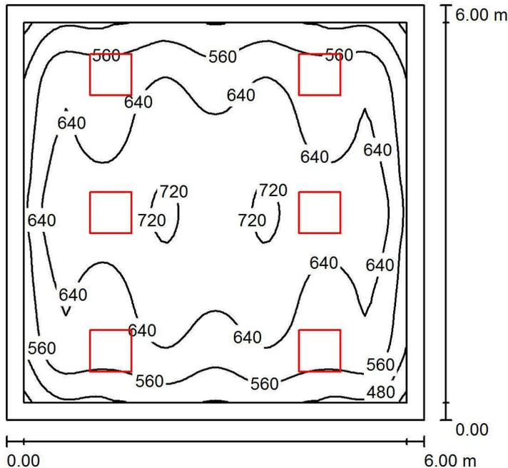
Altezza locale: 3.000 m, Altezza di montaggio: 3.062 m, Fattore di manutenzione: 0.90
