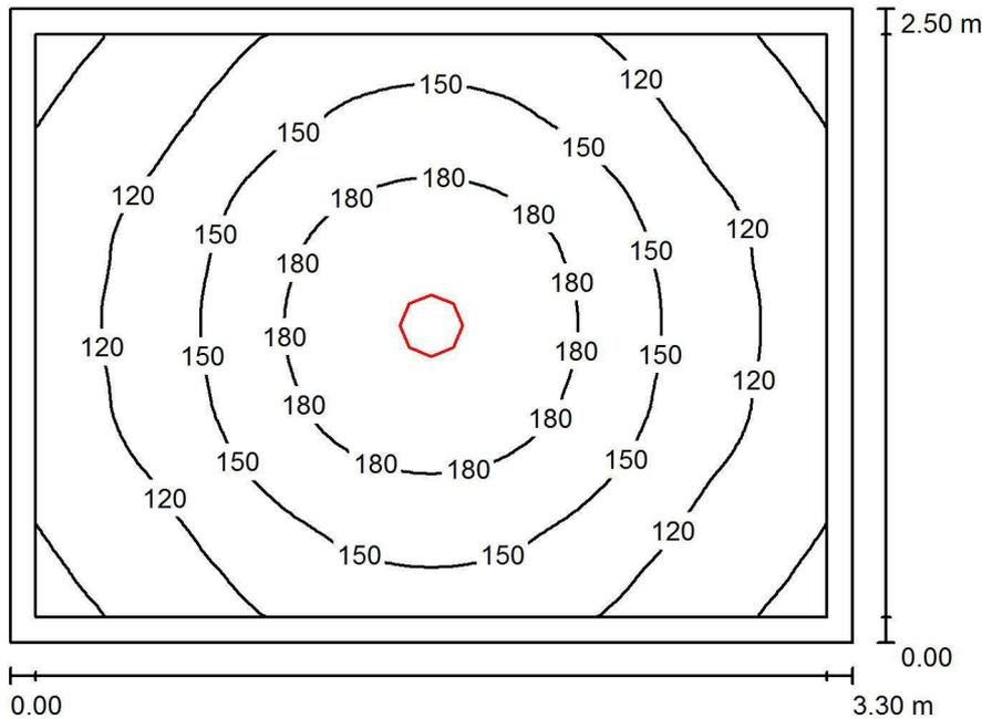
Altezza locale: 3.000 m, Altezza di montaggio: 3.062 m, Fattore di manutenzione: 0.90
