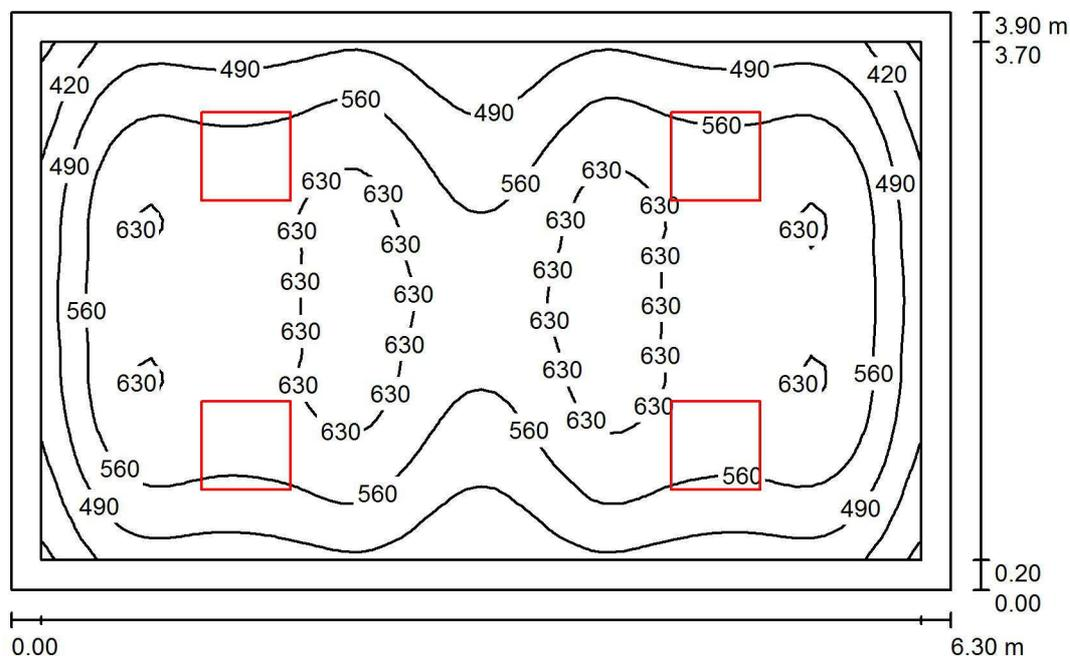
Altezza locale: 3.000 m, Altezza di montaggio: 3.062 m, Fattore di manutenzione: 0.90
