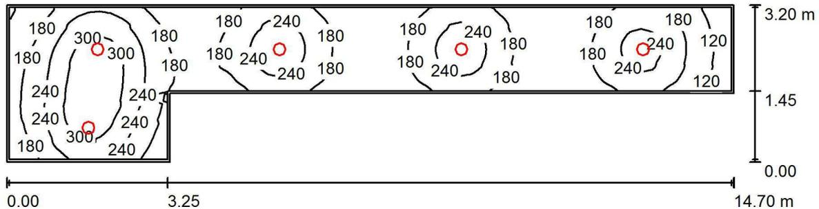
Altezza locale: 3.000 m, Altezza di montaggio: 2.862 m, Fattore di manutenzione: 0.90
