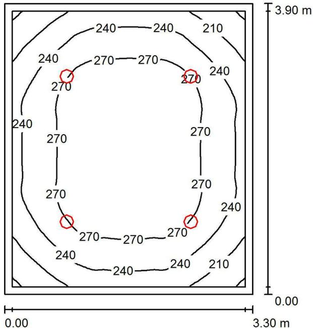
Altezza locale: 3.000 m, Altezza di montaggio: 3.062 m, Fattore di manutenzione: 0.90
