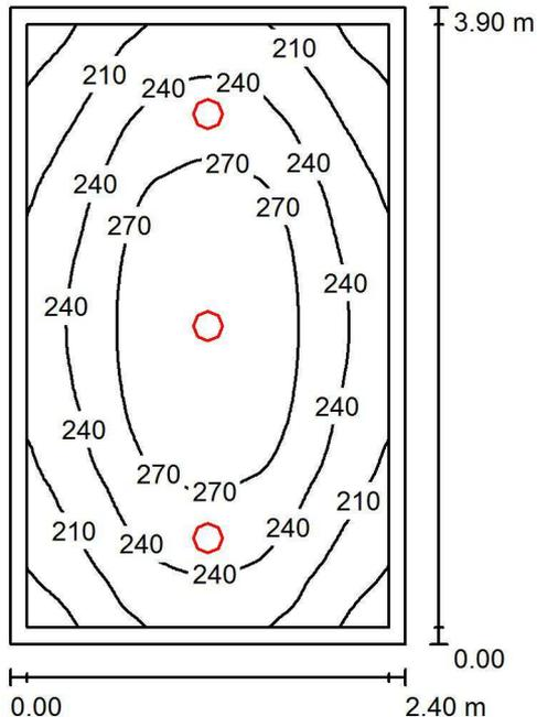
Altezza locale: 3.000 m, Altezza di montaggio: 3.062 m, Fattore di manutenzione: 0.90
