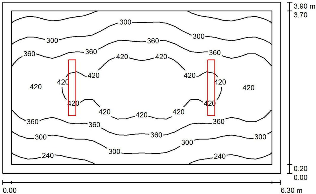
Altezza locale: 3.000 m, Altezza di montaggio: 3.000 m, Fattore di manutenzione: 0.80
