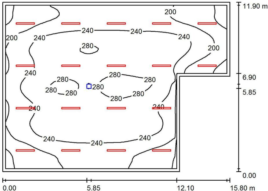
Altezza locale: 4.800 m, Altezza di montaggio: 4.800 m, Fattore di manutenzione: 0.80
