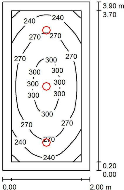
Altezza locale: 3.000 m, Altezza di montaggio: 3.062 m, Fattore di manutenzione: 0.90
