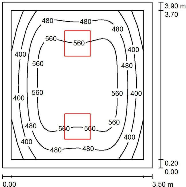
Altezza locale: 3.000 m, Altezza di montaggio: 3.062 m, Fattore di manutenzione: 0.90
