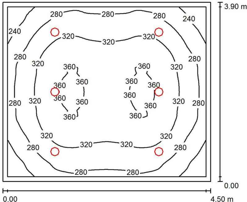
Altezza locale: 3.000 m, Altezza di montaggio: 3.062 m, Fattore di manutenzione: 0.90
