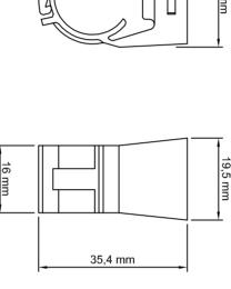
Staffe in nylon autobloccanti fissate a soffitto tramite viti in acciaio galvanizzato e tasselli in nylon (dimensione 6mm)
