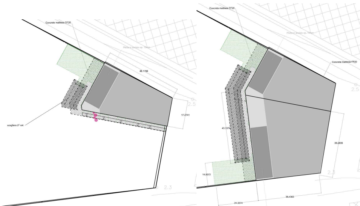
Figura 4: a sinistra la fase 1 dei lavori di bonifica e strutturali; a destra i lavori ultimati a seguito della fase 2; per ognuna delle due fasi sarà emessa una distinta certificazione di avvenuta bonifica
