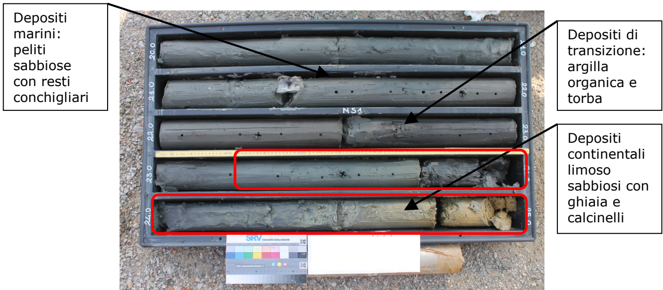
Foto n° 3: Successione di depositi marini pelitico sabbiosi (con resti di conchiglie), depositi di argille organiche e torbose, depositi continentali limoso argilloso con ghiaia e calcinelli (Sondaggio a mare "SRV Indagini Geologiche s.r.l." presso Piattaforma Logistica Trieste).
