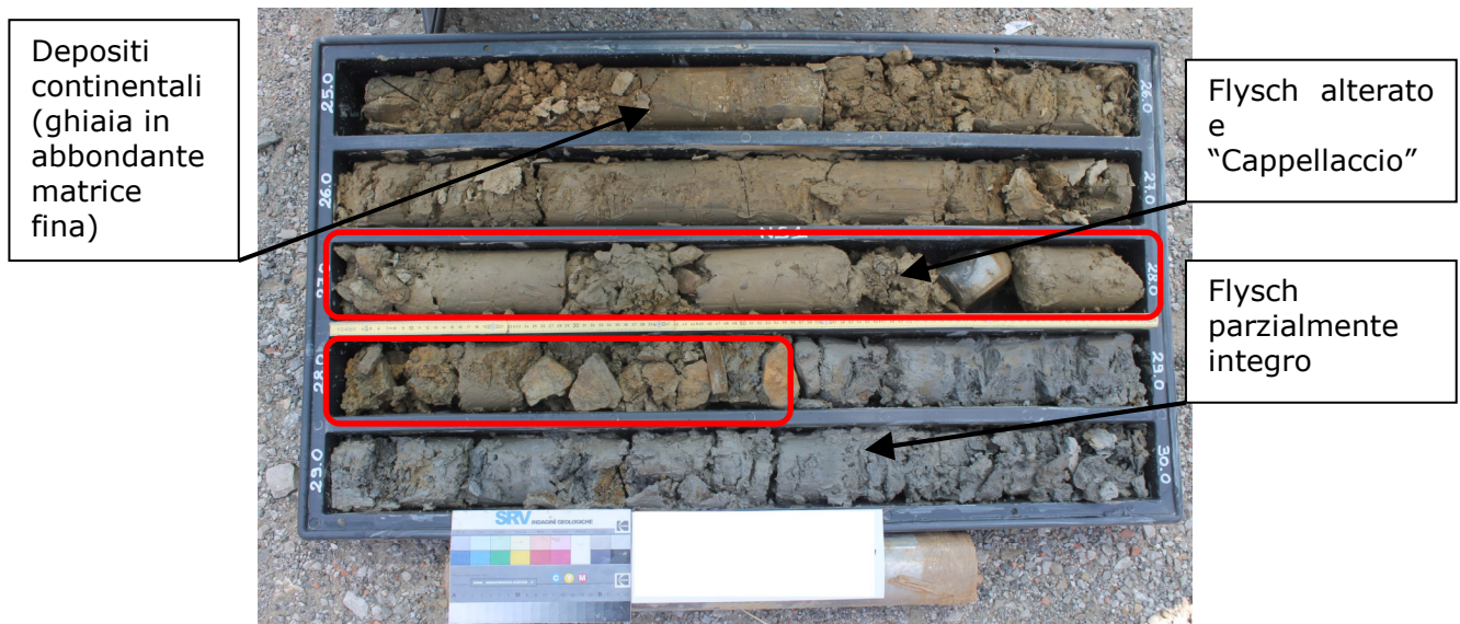
Foto n° 2: Depositi di copertura, di alterazione substrato parzialmente integro (Sondaggio a mare "SRV Indagini Geologiche s.r.l." Piattaforma Logistica Trieste).
