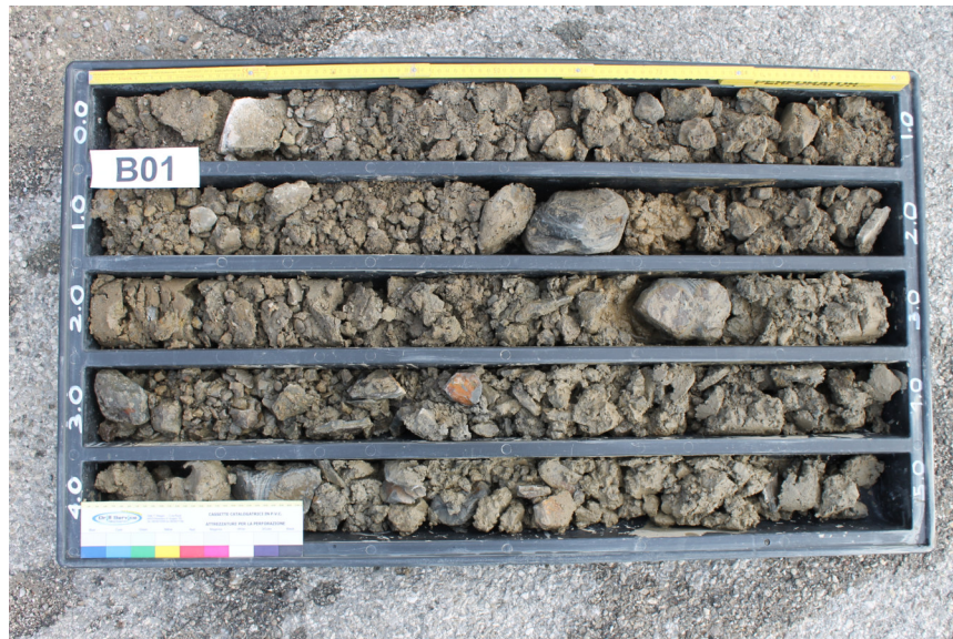
Foto n° 4: Tipologia materiale di riporto (Sondaggio area Stazione Ferroviaria "SRV Indagini Geologiche s.r.l."): ciottoli, frammenti lapidei etrometrici, matrice terrosa limo sabbiosa color marrone).
