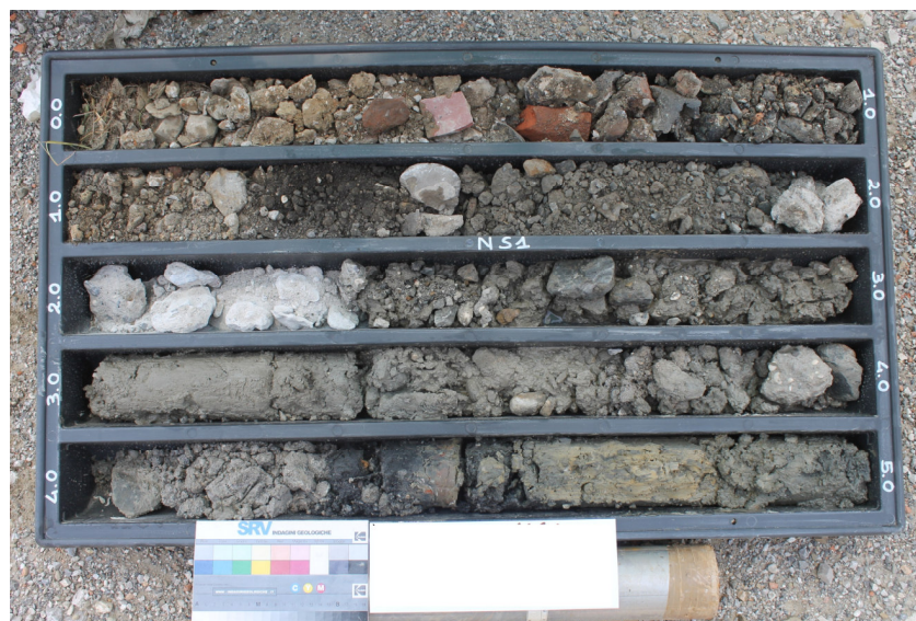
Foto n° 5: Tipologia materiale di riporto (Sondaggio area Ferriere di Servola "SRV Indagini Geologiche s.r.l."): ciottoli, frammenti di laterizi, blocchi calcarei e di calcestruzzo, scorie, limo e argilla).
