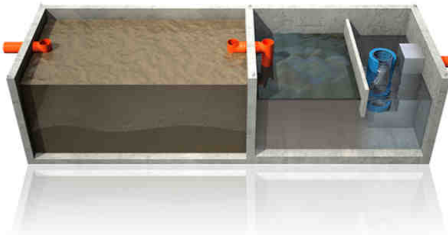
Figura 7: trattamento in continuo acque di seconda pioggia
