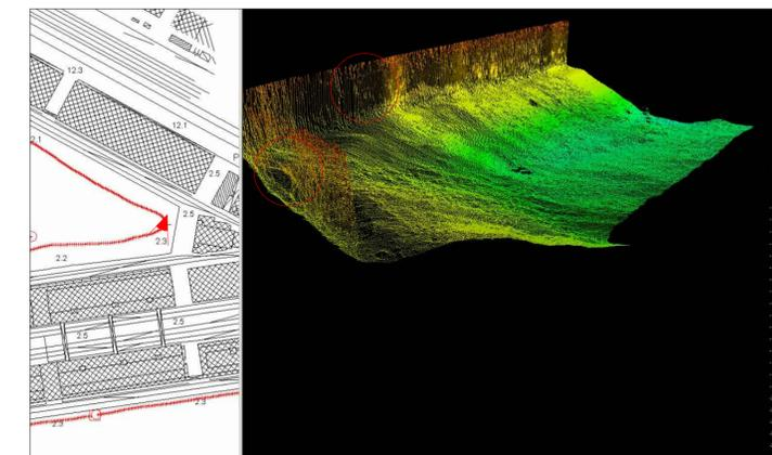
○ condizioni di instabilità riconducibili a mancanza di verticalità di tratti di banchina, presenza di cavità di dimensioni anche rilevanti
