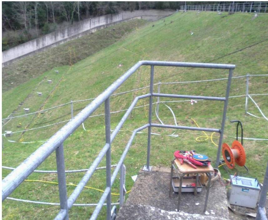
**Figura 4.6** – Georesistivimetro digitale Syscal R1plus, in acquisizione cross-cable, sul paramento di valle della diga.
