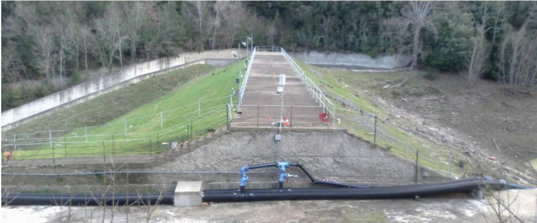
**Figura 4.4** – Misure della resistività elettrica in configurazione dipolo-dipolo 3D (cross-cable), tra elettrodi posti a monte ed a valle del coronamento della diga.
