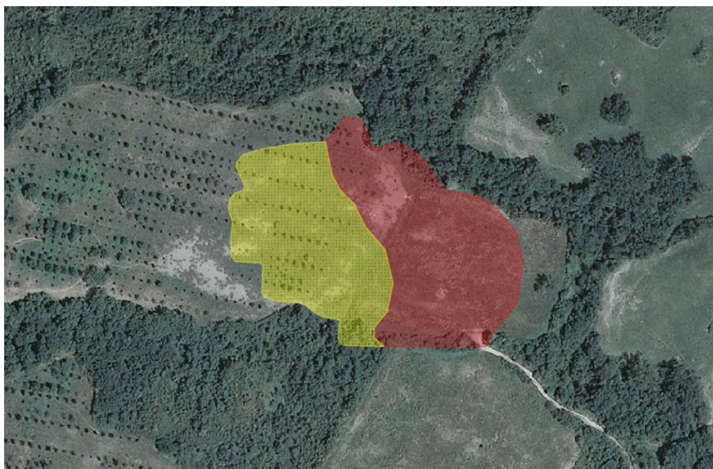
Figura 5-6 – Attività di scavo e riporto nel polo di reiniezione LUCIGNANO 2 (in giallo gli scavi, in rosso i riporti)
