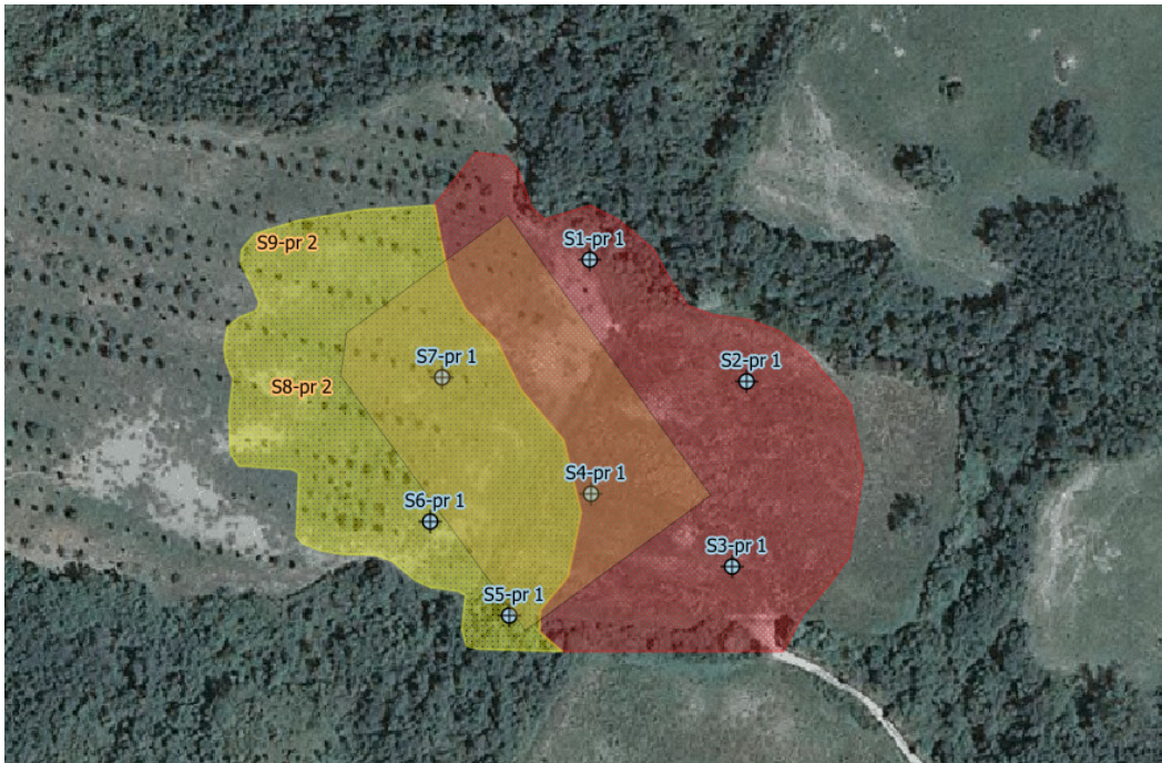
Figura 6-2 – Attività di scavo e riporto nel polo di reiniezione (in rosso gli scavi di profondità > 2 m, in arancio = 2 m, in celeste =1 m)
